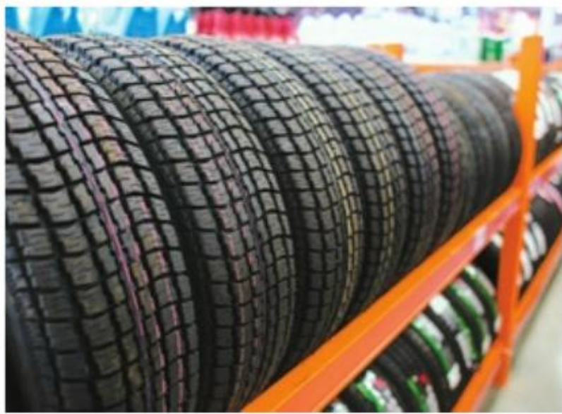
Opony wykonane m.in. z gumy połączonej z sadzą
