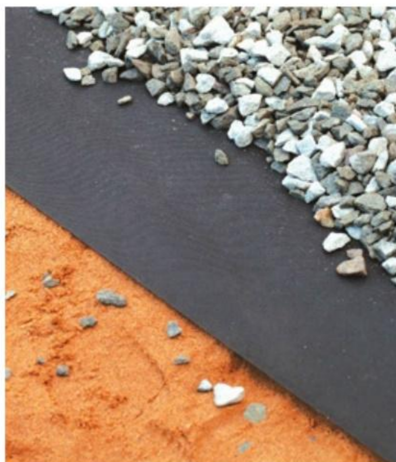
Geowłóknina w warstwie podkładowej drogi
