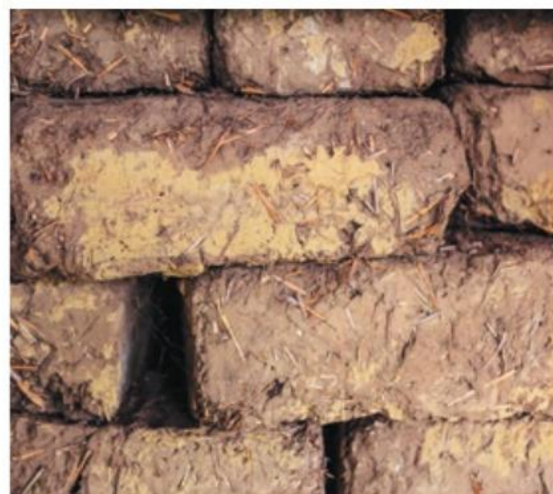
Cegły z gliny wzmocnionej słomą
