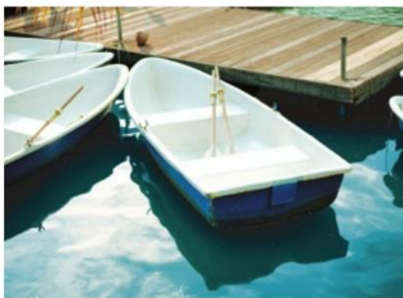
Łódka z laminatu – tworzywa z mat szklanych nasączonych żywicą poliestrową
