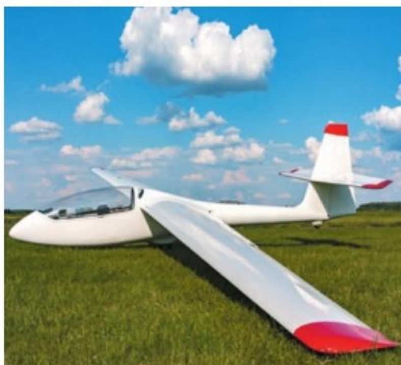
Szybowiec, którego poszycie wykonano z kompozytów
