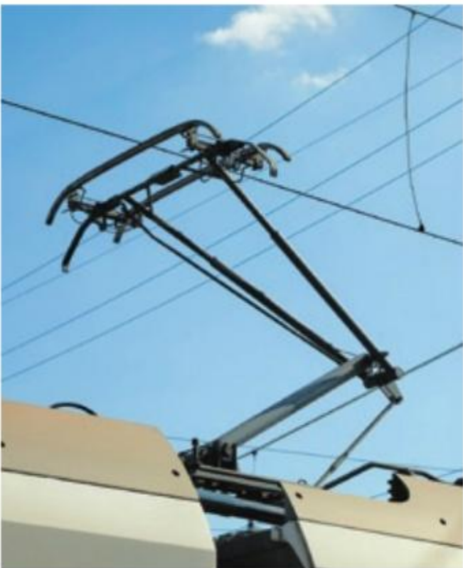
Pantograf – element łączący tramwaj z przewodami jezdny i odbierający prąd
