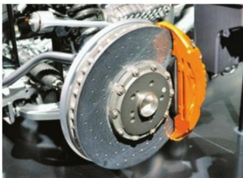
Tarcza hamulcowa z cermetu – materiału powstałego z połączenia ceramiki i metalu
