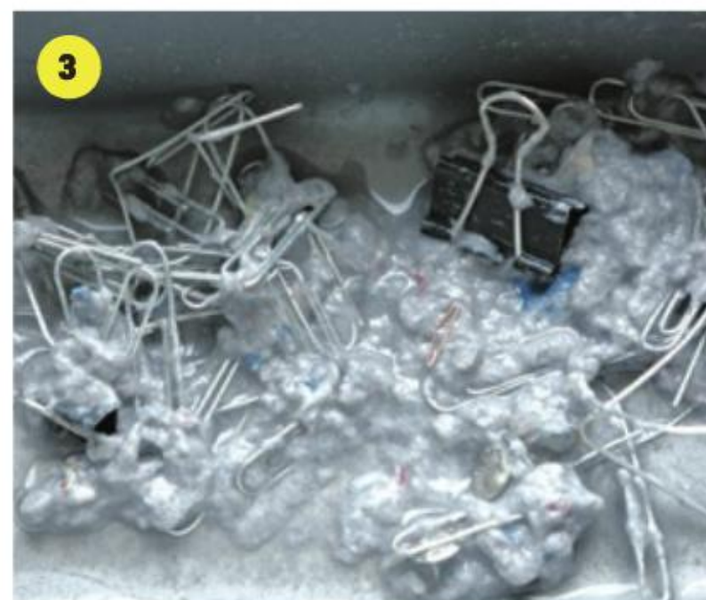
Usuwanie metalowych elementów
