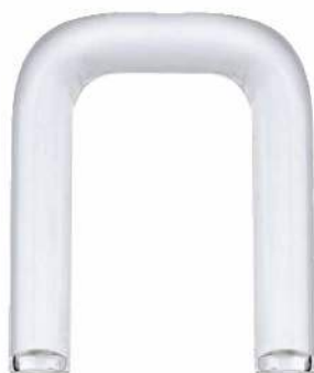
Fot. 73. Wygięta rurka zanurzona w roztworach elektrolitów wypełniona roztworem KCl to najczęściej stosowany klucz elektrolityczny.
