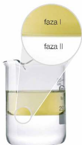
Fot. 79. Olej roślinny (faza I) i woda (faza II) tworzą układ heterogeniczny.
