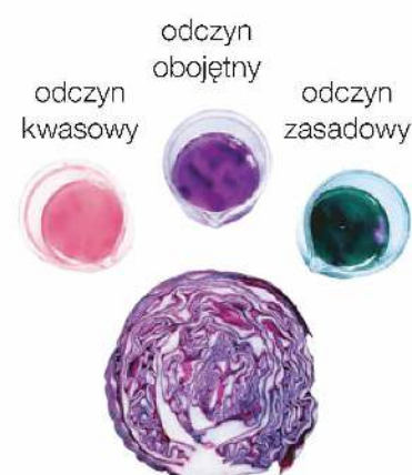
Fot. 126. Barwa soku z czerwonej kapusty, stosowanego w postaci roztworów wodnego lub alkoholowego, zmienia się w zależności od odczynu badanego roztworu.
