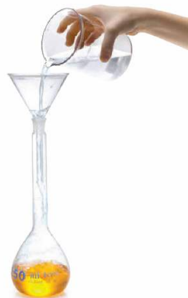
Fot. 100. Kolbę miarową dobiera się tak, aby jej pojemność była równa objętości roztworu, który chcemy sporządzić.
