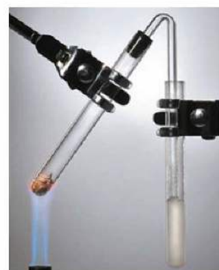
Fot. 53. Termiczny rozkład wapieni.
