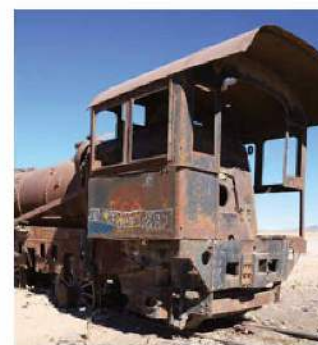
Fot. 75. Obecność wilgoci, tlenu oraz soli sprzyja korozji. Przyczyniają się do niej także wysokie temperatury.
