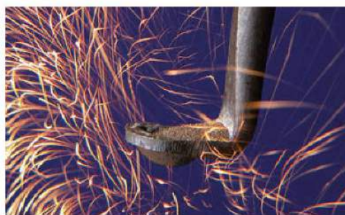
Fot. 111. Sproszkowane żelazo umieszczone w płomieniu palnika zapala się, a więc gwałtownie się utlenia. Ten efekt nie występuje podczas ogrzewania żelaznego pręta.
