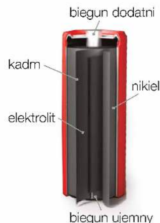
Rys. 47. W akumulatorze niklowo-kadmowym elektrolitem jest wodorotlenek potasu.
