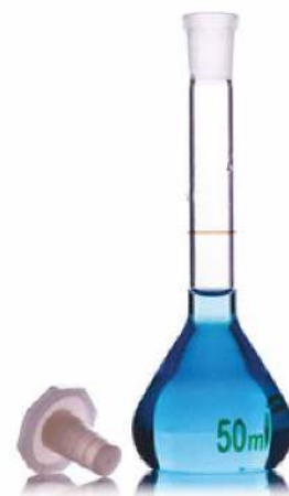
Fot. 99. Na szyjce kolby miarowej znajduje się kreska wskazująca poziom cieczy odpowiadający pojemności kolby.
