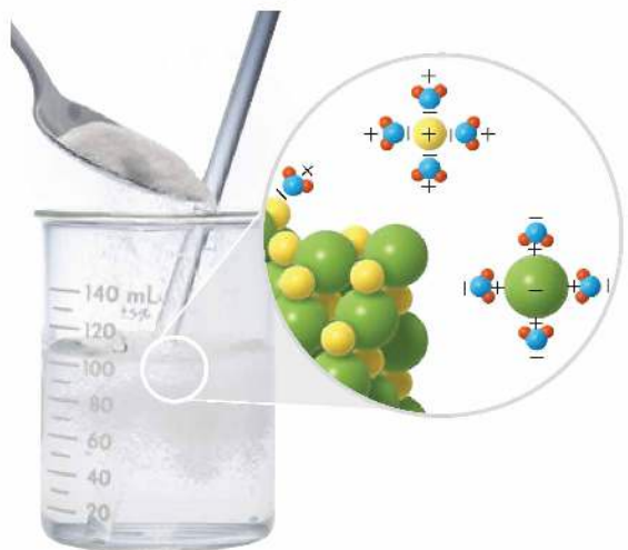
Rys. 34. Model procesu rozpuszczania \text{NaCl} w wodzie.
