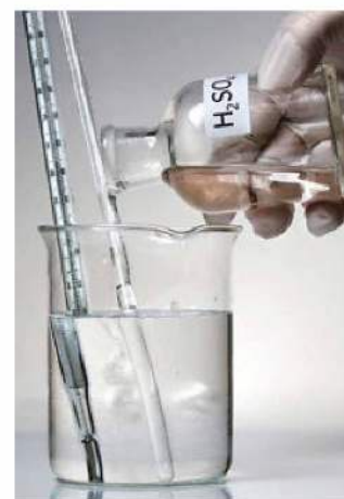
Fot. 164. Stężony roztwór \text{H}_2\text{SO}_4 wleany do wody opada na dno zlewki i tam stopniowo miesza się z wodą. Jest to proces silnie egzotermiczny.
