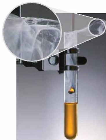
Fot. 43. W wyniku spalania fosforu czerwonego powstaje tlenek fosforu(V).
