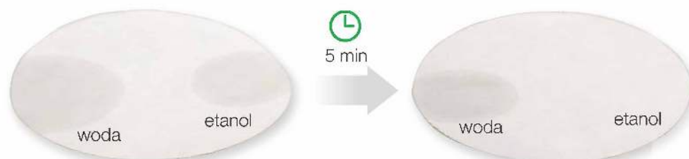
Fot. 54. Etanol i woda zostały naniesione na krążek bibuły w tym samym czasie. Po 5 min plama z wody nadal była widoczna, a etanol odparował całkowicie.
