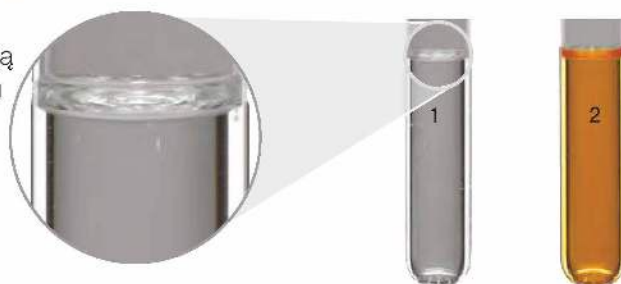
Fot. 172. Reakcja wody bromowej, w obecności wodorowęglanu sodu, z wodnym roztworem glukozy (probówka 1.) i fruktozy (probówka 2.).
