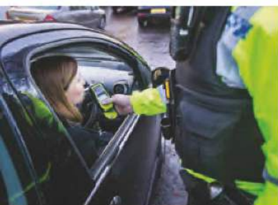
Fot. 57. Alkomat służy do badania zawartości alkoholu w wydychanym powietrzu.
