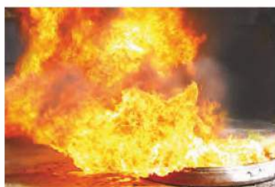
Fot. 28. Do gaszenia palącej się ropy naftowej używa się piasku lub gaśnic śniegowych wypełnionych tlenkiem węgla(IV).
