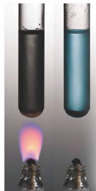
Fot. 88. Reakcja kwasu etanowego z tlenkiem miedzi(II).
