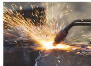
Fot. 16. W palnikach acetylenowo-tlenowych zachodzi reakcja spalania całkowitego etynu.
