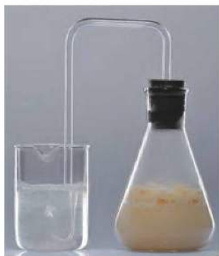
Fot. 48. Mętnienie wody wapiennej powoduje tlenek węgla(IV) – produkt uboczny fermentacji alkoholowej.
