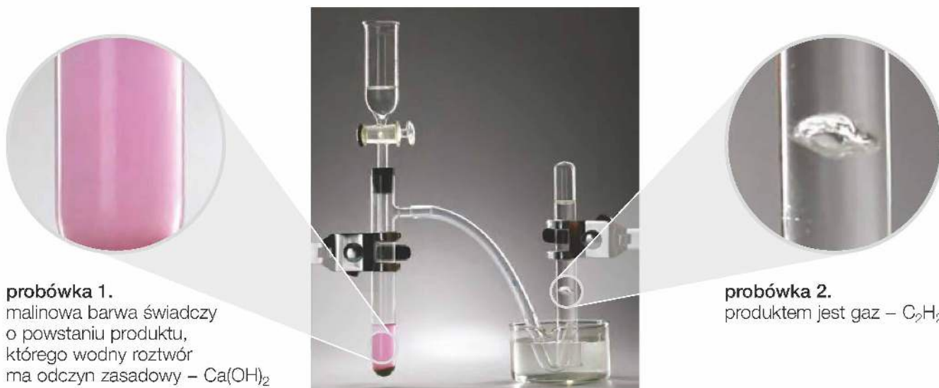
Fot. 18. Otrzymywanie etynu w reakcji karbidu z wodą.
