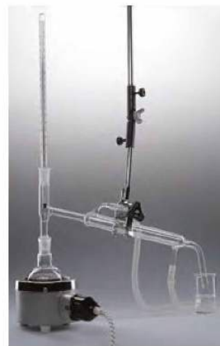
Fot. 29. Ropa naftowa jest cieczą łatwopalną, dlatego w doświadczeniu stosuje się ogrzewanie elektryczne – czaszę grzejną.
