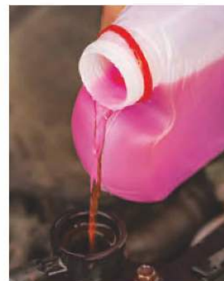
Fot. 61. Etano-1,2-diol ze względu na swoje właściwości fizyczne jest składnikiem płynu do chłodnic samochodowych.
