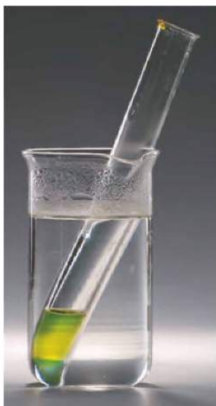
Fot. 82. Zmiana barwy roztworu świadczy o tym, że zaszła reakcja chemiczna.
