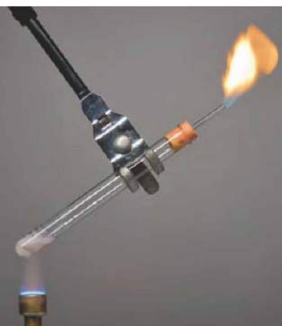
Fot. 56. Doświadczenie należy wykonywać pod wyciągiem, ponieważ produkty tej reakcji są łatwopalne i toksyczne.
