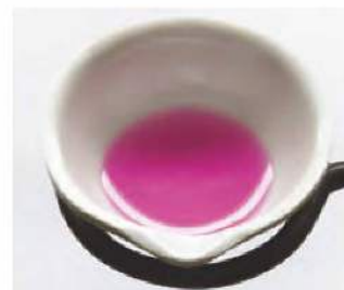
Fot. 96. Zabarwienie fenoloftaleiny świadczy o zasadowym odczynie roztworu wodorotlenku sodu.
