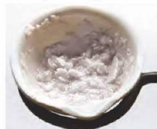
Fot. 98. Produkt reakcji kwasu stearynowego z wodorotlenkiem sodu jest substancją stałą, śliską w dotyku.
