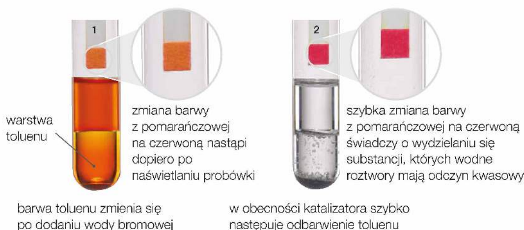
Fot. 33. Barwa uniwersalnego papierka wskaźnikowego po dodaniu wody bromowej do toluenu w próbówce 1. lub toluenu z bromkiem żelaza(III) w próbówce 2.
