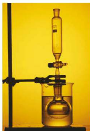
Fot. 32. Nitrowanie jest reakcją egzotermiczną. Zazwyczaj przeprowadza się je w temperaturze ok. 60–70°C. Dlatego kolbę reakcyjną trzeba ochładzać, zanurzając ją w zimnej wodzie.
