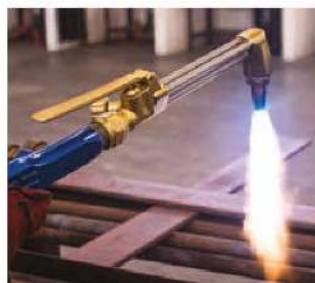
Fot. 26. Temperatura płomienia palnika acetylenowo-tlenowego wynosi ok. 3000°C.
