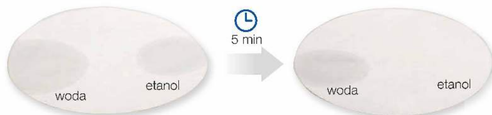
Fot. 60. Porównanie lotności etanolu i wody.
