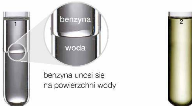
Fot. 46. Mieszanina benzyny z wodą (probówka 1.) i olejem (probówka 2.).
