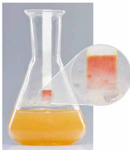
Fot. 125. Reakcja aniliny z wodą bromową.
