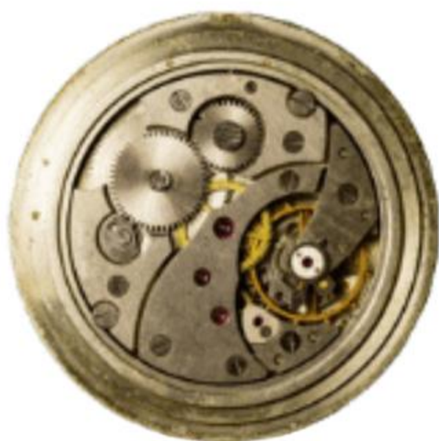
W zegarku mechanicznym „wahadłem” jest balans – kółko obracające się na sprężynie tam i z powrotem.
