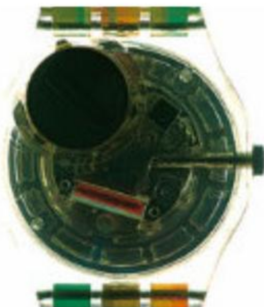
W zegarku elektronicznym „wahadło” jest ukryte – jego funkcję pełni drgający kryształek kwarcu.
