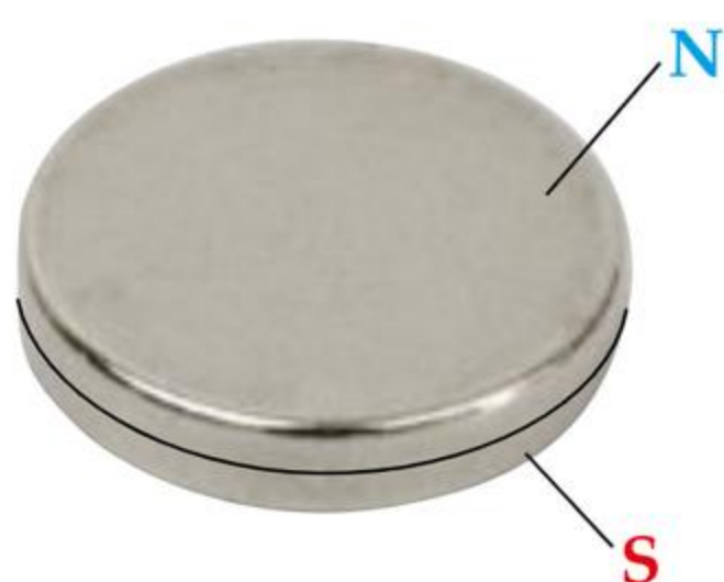
Magnes neodymowy z zaznaczonymi biegunami magnetycznymi.
