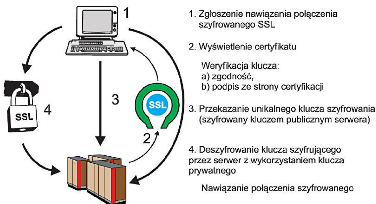
Rys. 33.1. Działanie połączenia szyfrowanego SSL
