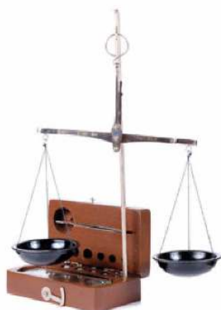
Rys. 1.9. Na wadze szalkowej masę ważonego ciała porównujemy z masą wzorca – odważnika
