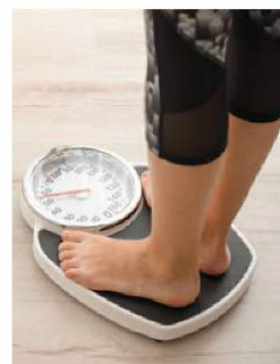
Rys. 4.26. Do pomiaru ciężaru w windzie najlepiej użyć wagi sprężynowej – pomiar w większości wag elektronicznych trwa zbyt długo, aby wykorzystać je w windzie
