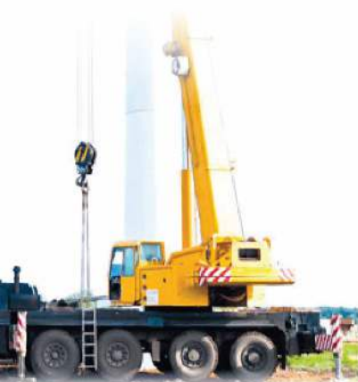
Rys. 6.20. Aby obniżyć środek ciężkości, dolna część dźwigu jest mocno obciążana
