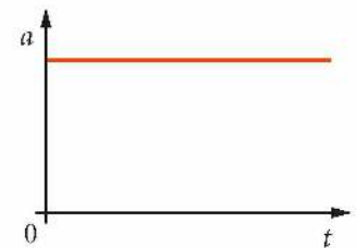
Rys. 2.32. Wykres zależności przyspieszenia od czasu w ruchu jednostajnie zmiennym
