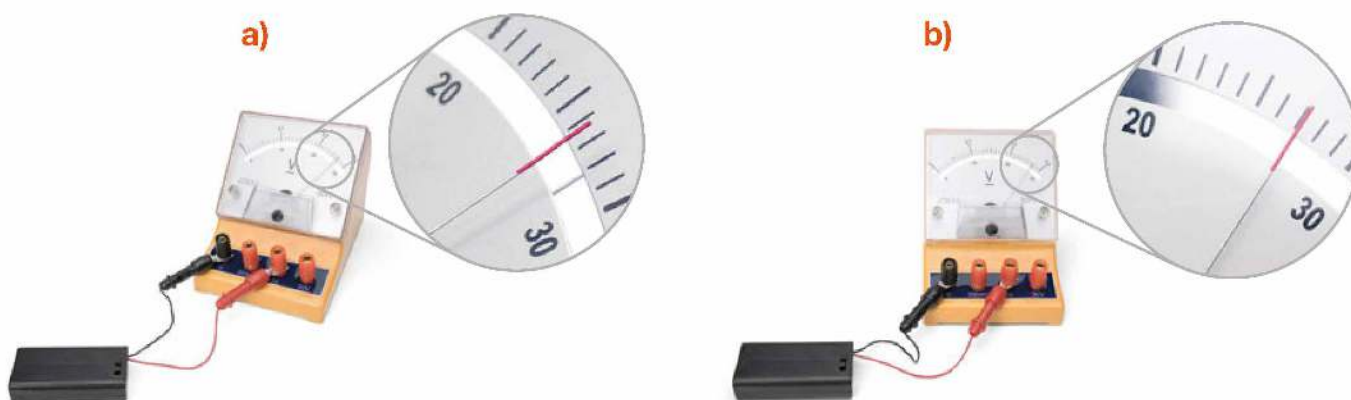
Rys. 1.16. Błąd odczytu (a) można zminimalizować np. dzięki umieszczeniu zwierciadła na tarczy miernika. Wówczas patrzymy na tarczę tak, aby wskazówka pokrywała się ze swoim odbiciem (b)
