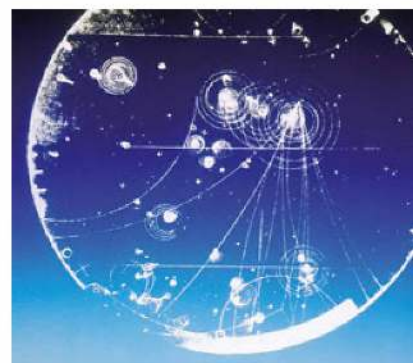
Rys. 14.24. Tory cząstek w komorze pęcherzykowej
