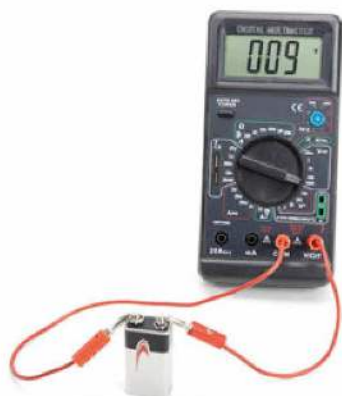
Rys. 13.52. Kiedy podłączamy woltomierz do nieobciążonej baterii, mierzymy jej SEM
