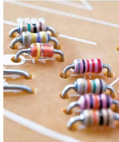
Rys. 13.32. W kolorowych paskach zakodowano opór oporników (tabela s. 346)
