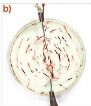
Rys. 12.18. Skrawki wstążki układają się wzdłuż linii pola elektrycznego wytworzonego przez dwa punktowe źródła pola: a) o tym samym znaku, b) o przeciwnych znakach
