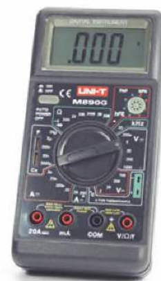
Rys. 13.17. Ten sam miernik uniwersalny może służyć do pomiaru napięcia, natężenia i oporu
