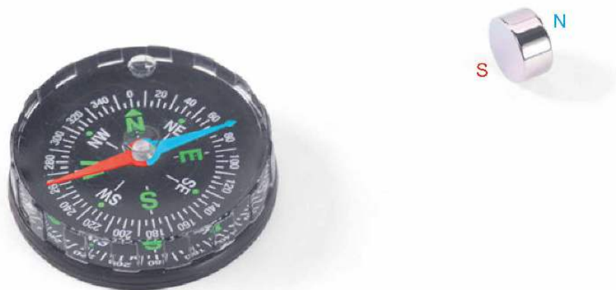
Rys. 14.9. Rozpoznawanie biegunów magnesu za pomocą igły magnetycznej
