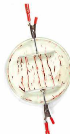
Rys. 12.16. Skrawki wstążki układają się wzdłuż linii pola elektrycznego wytworzonego przez dwie równoległe płytki
