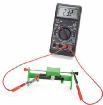
Rys. 13.36. Miernik uniwersalny włączony jako omomierz. Jako opornik został podłączony potencjometr
