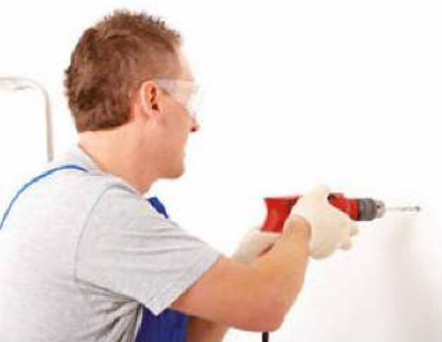
Rys. 15.33. Podczas wiercenia w betonie wiertło, a więc i silnik obracają się wolniej. Siła elektromotoryczna indukcji jest mniejsza i przez silnik płynie prąd o większym natężeniu
