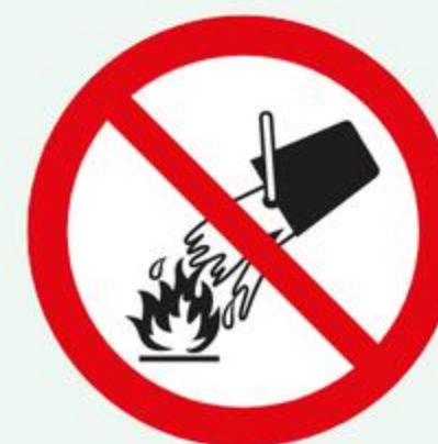
Zakaz gaszenia wodą
