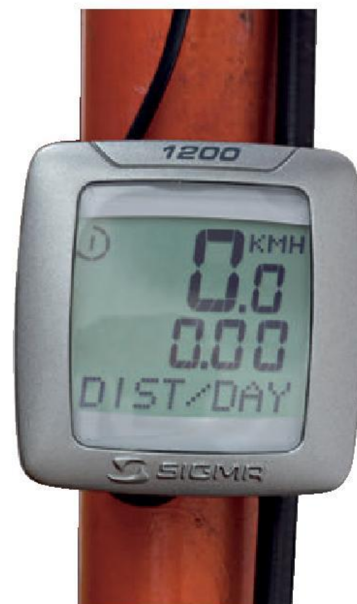
Prędkościomierz rowerowy informuje także o przebytej drodze i czasie jazdy.
