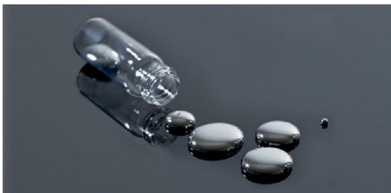
Rtęć w temperaturze pokojowej (20°C) jest cieczą, ale jeśli temperaturę obniży się do poniżej -39^{\circ}\text{C} , stanie się ciałem stałym. Termometry rtęciowe są stosowane np. w laboratoriach.
