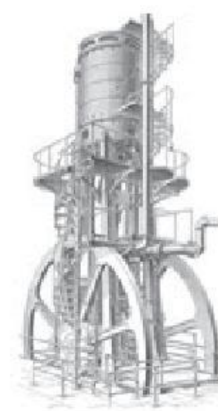
Dmuchawa napędzana silnikiem parowym z XIX w.
