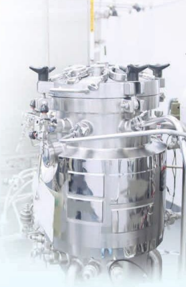
W fabrykach farmaceutycznych grzyby z rodzaju Penicillium i inne mikroorganizmy hoduje się w bioreaktorach – urządzeniach, które utrzymują idealne warunki do ich rozwoju.
