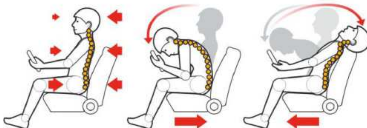
Mechanizm powstawania urazu biczowego kręgosłupa
