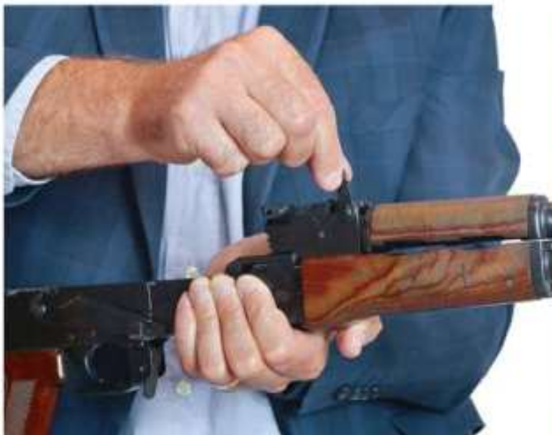
Odłączanie rury gazowej
