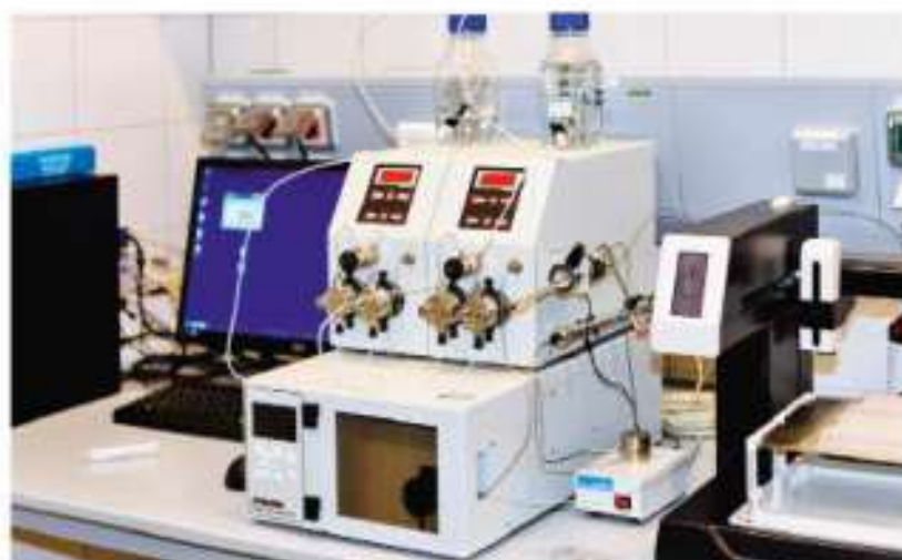
Ryc. II.6.15. Chromatograf cieczowy służy do rozdzielania i identyfikacji lipidów.
