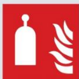
F014 – Stacja spustowa
