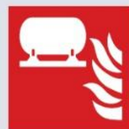
F012 – Stała instalacja gaśnicza
