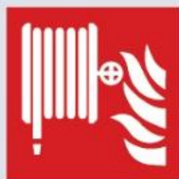
F002 – Hydrant wewnętrzny
