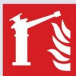
F015 – Monitor pożaru
