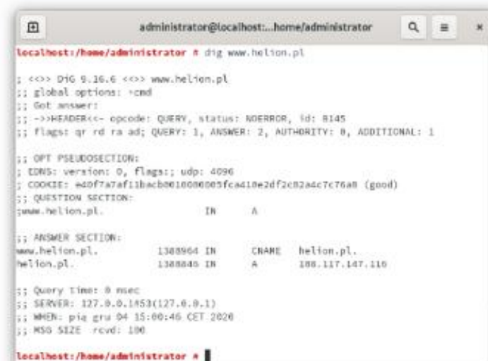
Rysunek 2.44. Sprawdzenie poprawności działania serwera DNS za pomocą polecenia dig
