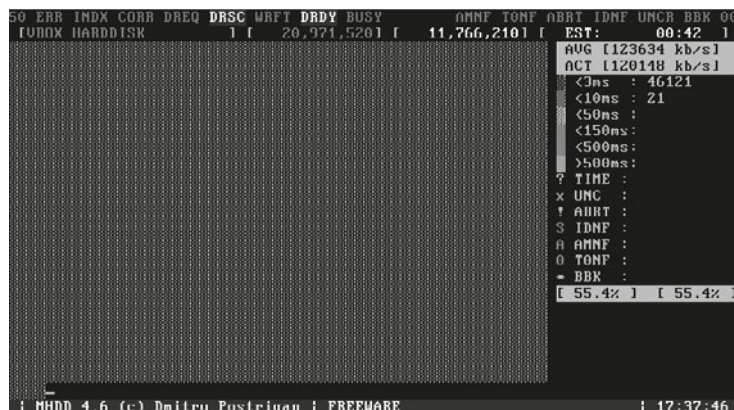
Rysunek 18.7. Proces skanowania powierzchni dysku przez program MHDD
