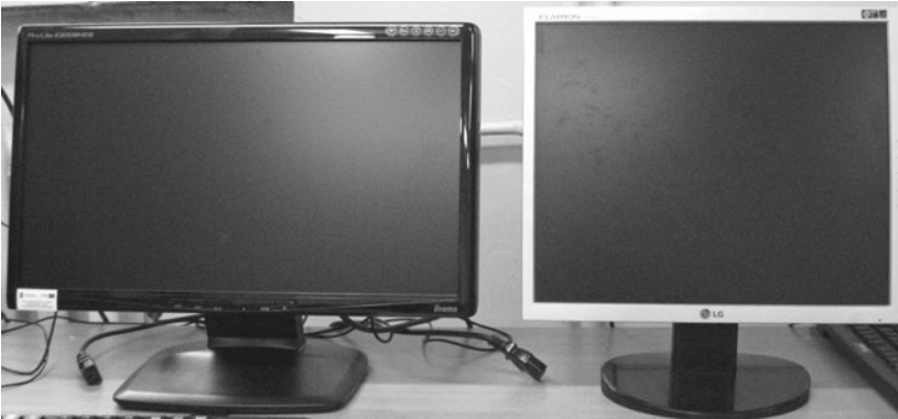
Rysunek 4.4. Monitory LCD z ekranem w formacie 16:9 i 4:3
