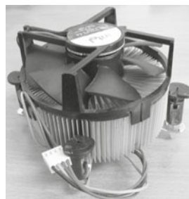
Rysunek 2.27. Radiator aktywny w kształcie walca z ożebrowaniem poprzecznym
