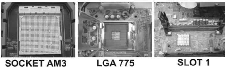
Rysunek 2.24. Zestawienie typów gniazd Socket, Slot i LGA
