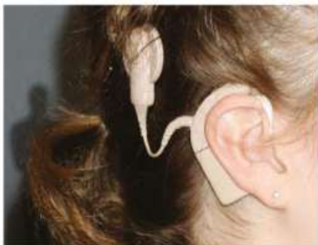
Ryc. VII.2.12. Implant ślimakowy jest urządzeniem elektronicznym przekształcającym dźwięki w sygnały elektryczne, które są wysyłane prosto do nerwu słuchowego z ominięciem uszkodzonych obszarów ucha.
