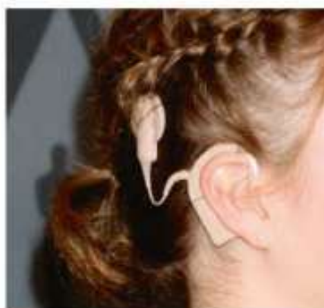
Ryc. I.17.5. Implant ślimakowy jest urządzeniem elektronicznym przekształcającym dźwięki w sygnały elektryczne, które są wysyłane prosto do nerwu słuchowego, z ominięciem uszkodzonych obszarów ucha.
