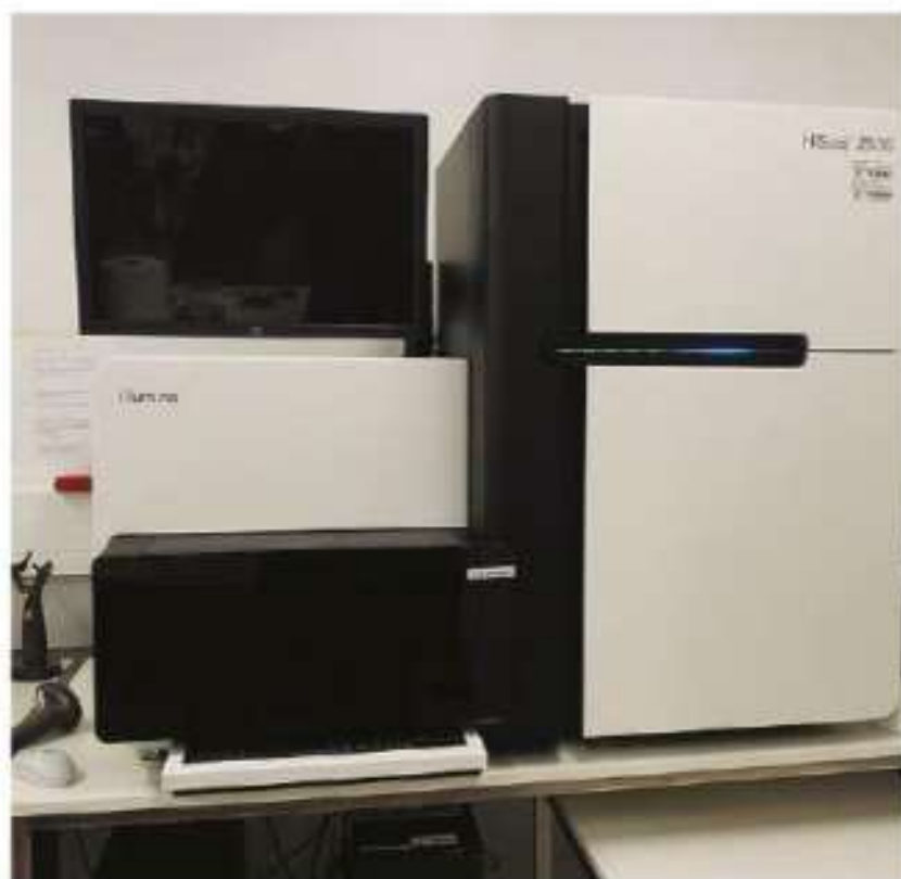
Ryc. II.1.6. Sekwenator służy do analizy kolejności nukleotydów w DNA.
