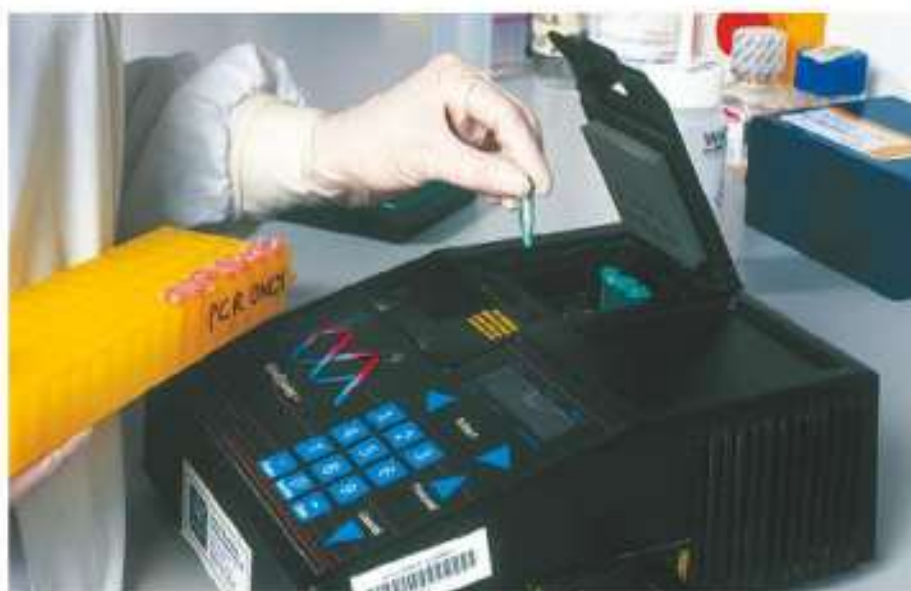
Ryc. V.3.3. W termocyklerach przeprowadza się reakcję PCR.
