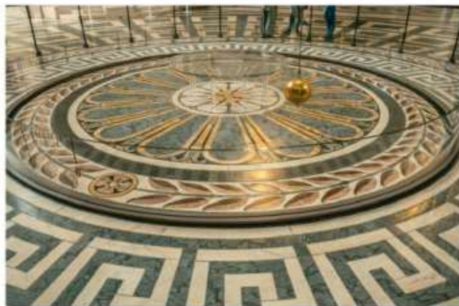
Rys. 18. Wahadło Foucaulta w paryskim Panteonie. Na skutek ruchu wirowego Ziemi płaszczyzna drgań wahadła zmienia swoją orientację.
