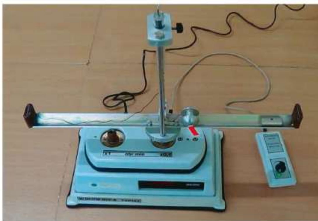
Rys. 22. Aparatura do pomiaru zależności siły dośrodkowej od masy ciała i parametrów jego ruchu.
