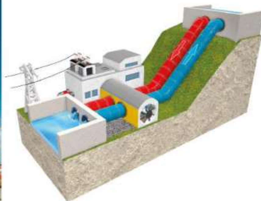
Rys. 42. Przykłady zastosowania energii potencjalnej grawitacji w praktyce: a) kafar, b) elektrownia szczytowo-pompowa.
