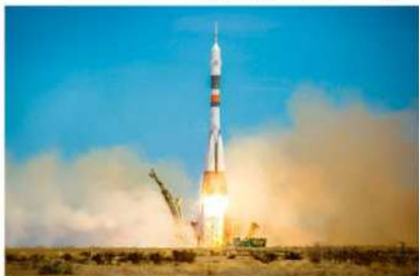
Rys. 4. Rakiety kosmiczne zbudowane są z wielu członów napełnionych paliwem. W miarę jego wyczerpywania się człony są odrzucane, by zmniejszyć masę rakiety.
