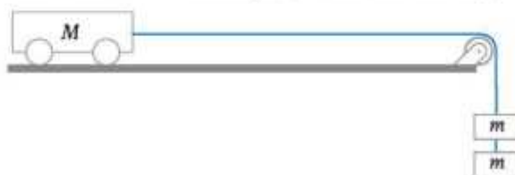
Rys. 13. Układ doświadczalny do badania zależności przyspieszenia układu ciał od jego masy i działającej siły.
