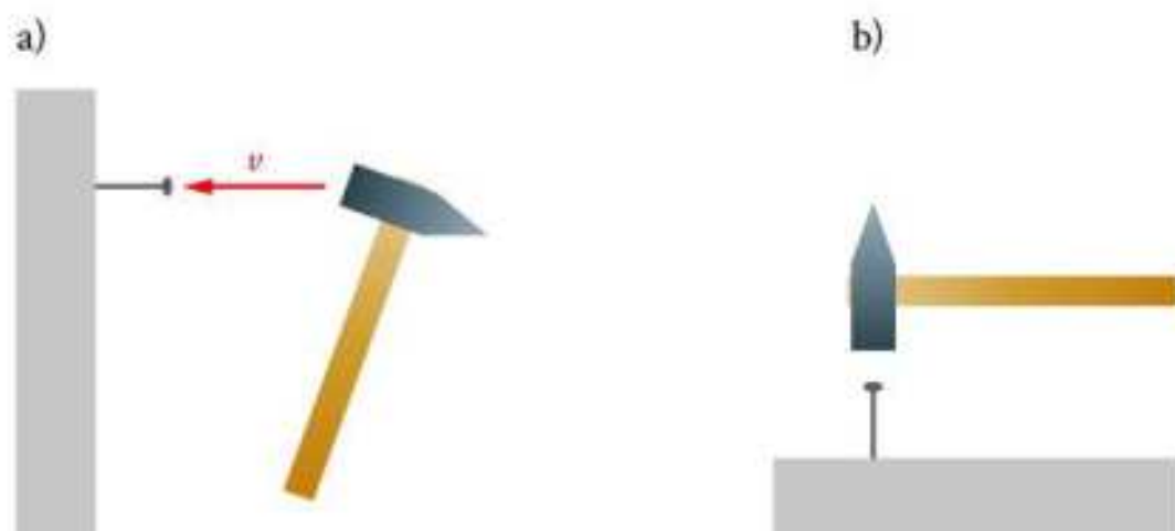
Rys. 36. a) rozpędzony młotek może wbić gwóźdź, ponieważ posiada energię kinetyczną, b) uniesiony młotek może wbić gwóźdź, bo ma energię potencjalną grawitacji.
