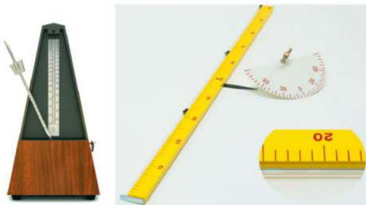
Rys. 7. Metronom i przyrząd do badania ruchu jednostajnego (rurka z wodą i pęcherzykiem powietrza przymocowana do podziałki).
