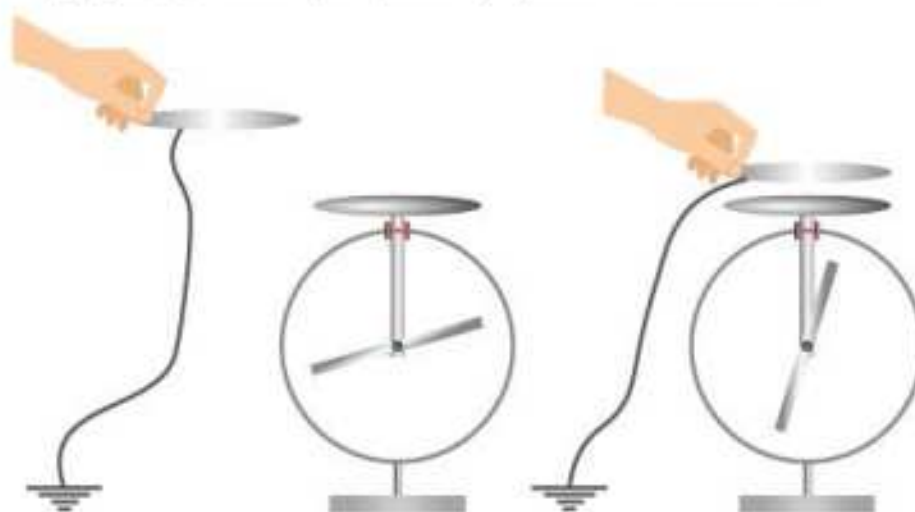
Rys. 23. Zbliżenie do naładowanego elektroskoku uziemionej płyty metalowej powoduje zmniejszenie się wychylenia wskazówki elektroskoku.
