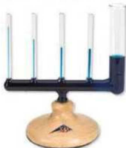
Rys. 33. Włoskowatość w naczyniach połączonych. Im cieńsza rurka, tym mniejszy ciężar znajdującej się w niej cieczy i siłom przylegania łatwiej jest wciągnąć ją do góry.
