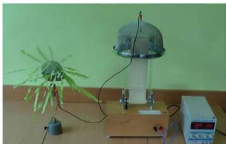
Rys. 13. Demonstracja linii pola elektrycznego za pomocą generatora Van de Graaffa i pasków bibuły.
