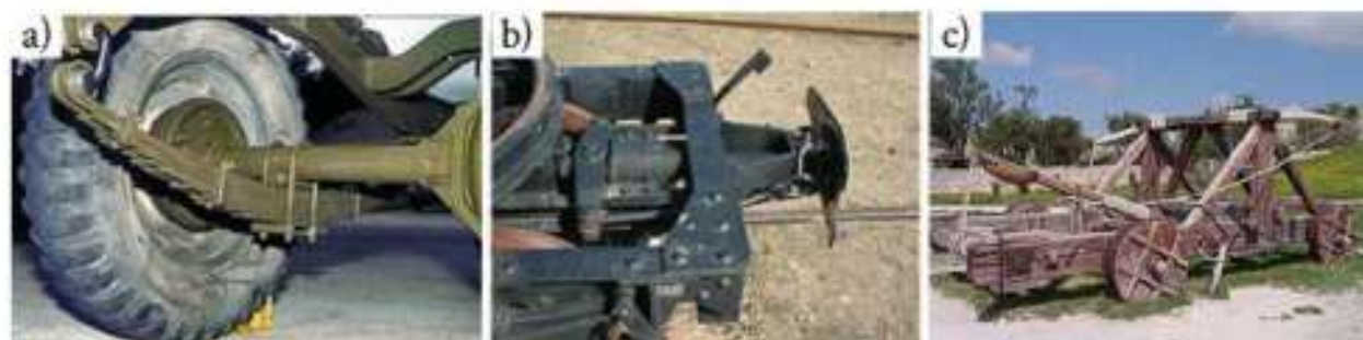
Rys. 7. Przykładowe praktyczne zastosowania zjawiska sprężystości: a) resor piórowy, b) zderzak kolejowy, c) katapulta.
