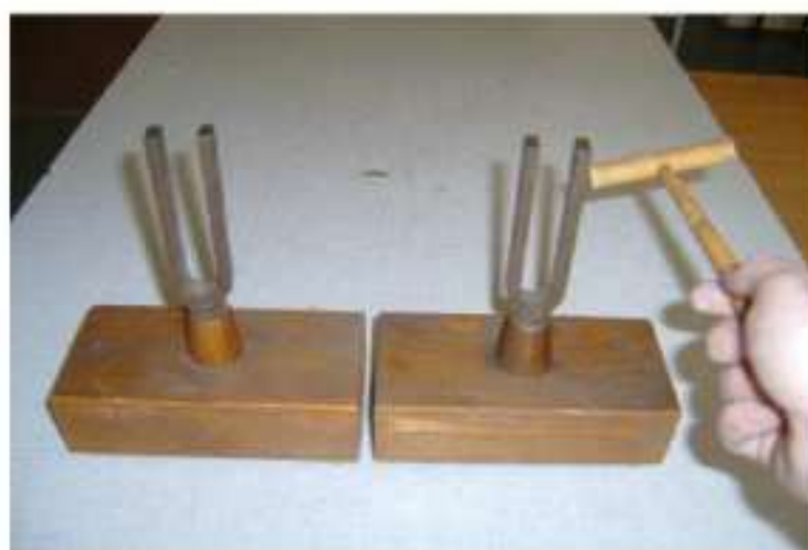
Rys. 27. Rezonans akustyczny zachodzący pomiędzy dwoma identycznymi kamertonami.
