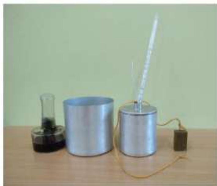
Rys. 25. Przyrządy do wykonania doświadczenia: palnik spirytusowy, kalorymetr, termometr, bryłka metalu na sznurku.
