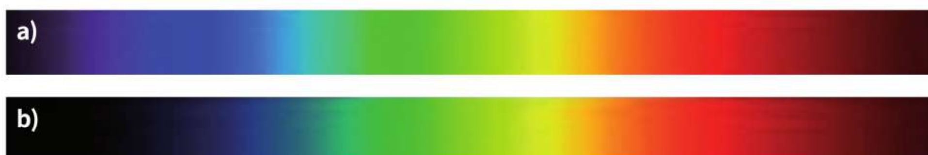
Ryc. 25.3. Dwa widma tej samej żarówki zasilanej wyższym (a) i niższym (b) napięciem. Natężenie koloru niebieskiego w widmie jest wyraźnie słabsze, gdy temperatura włókna żarówki jest niższa
