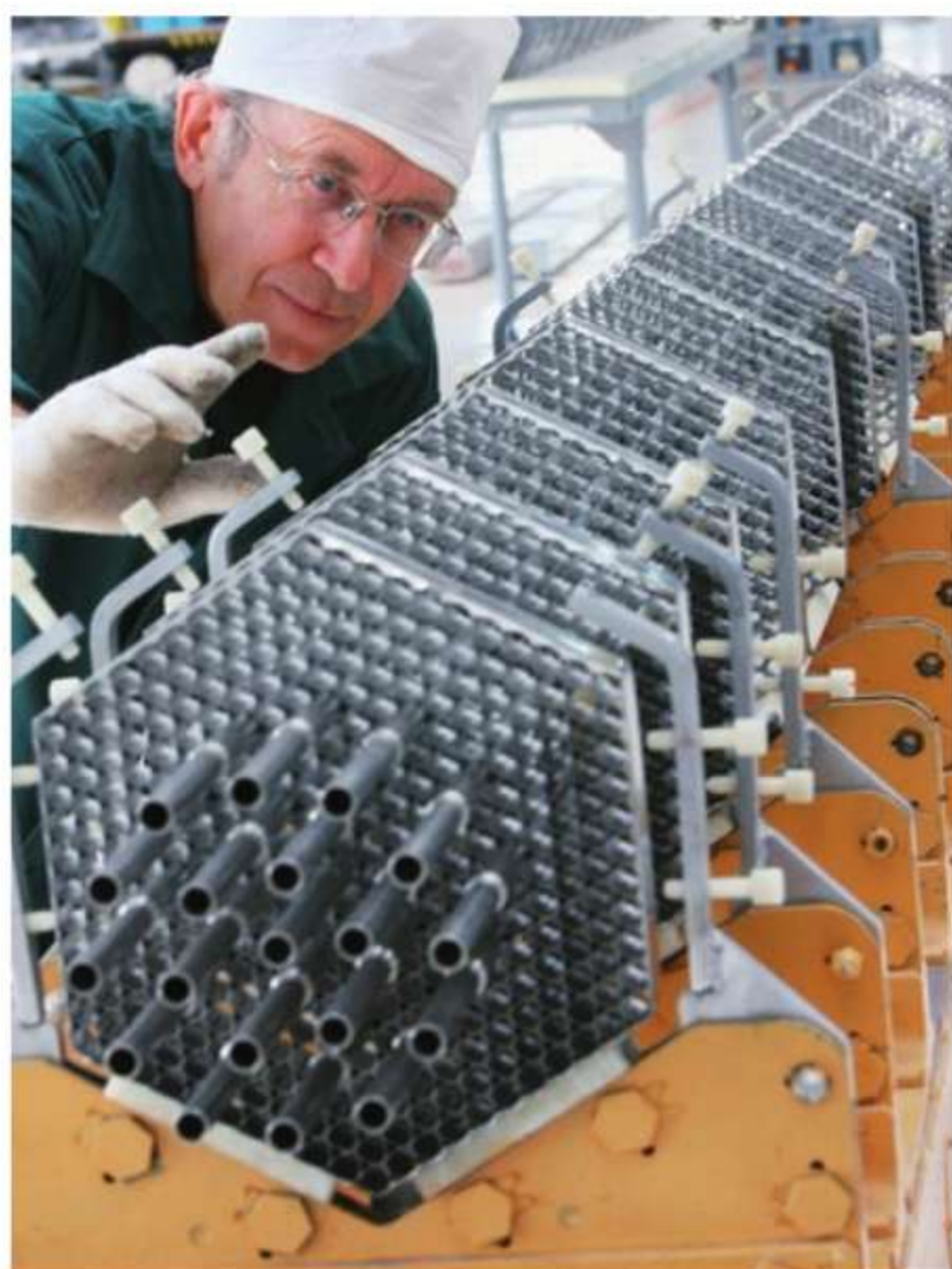
Ryc. 35.3. W fabryce produkującej pręty paliwowe do elektrowni jądrowych nie stosuje się nadzwyczajnych środków ochronnych, mimo że takie pręty zawierają uran
