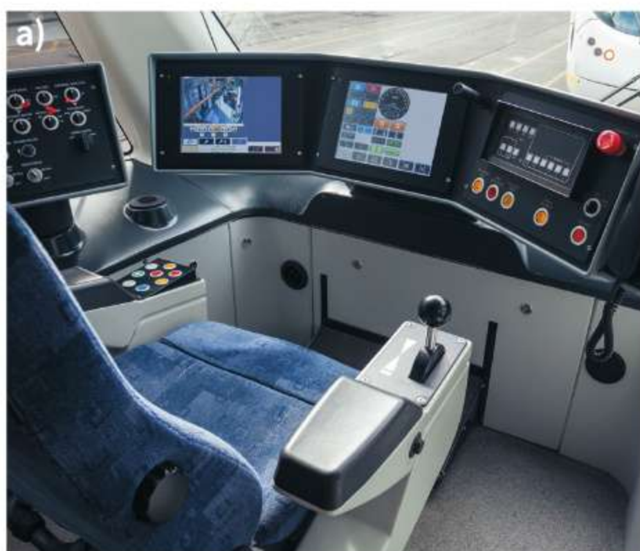
Ryc. 30.6. a) Stanowisko kierującego we współczesnym tramwaju. b) W dawnym tramwaju za pomocą korby przekręcano wyłącznik zasilania, który znajdował się w szafce poniżej
