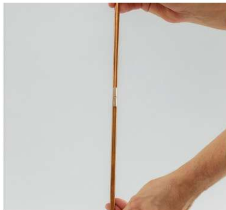
Ryc. 21.5. a) Powstawanie prądu indukcyjnego w zwojnicy podczas zbliżania magnesu. b) Hamowanie spadającego magnesu w miedzianej rurce
