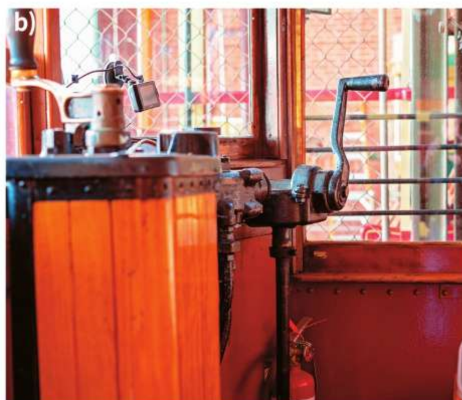
Ryc. 30.6. a) Stanowisko kierującego we współczesnym tramwaju. b) W dawnym tramwaju za pomocą korby przekręcano wyłącznik zasilania, który znajdował się w szafce poniżej
