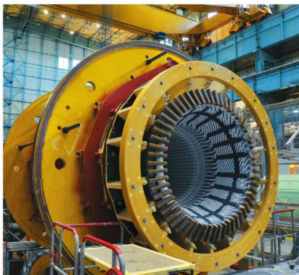
Ryc. 21.4. Zewnętrzna część prądnicy, która będzie używana w elektrowni
