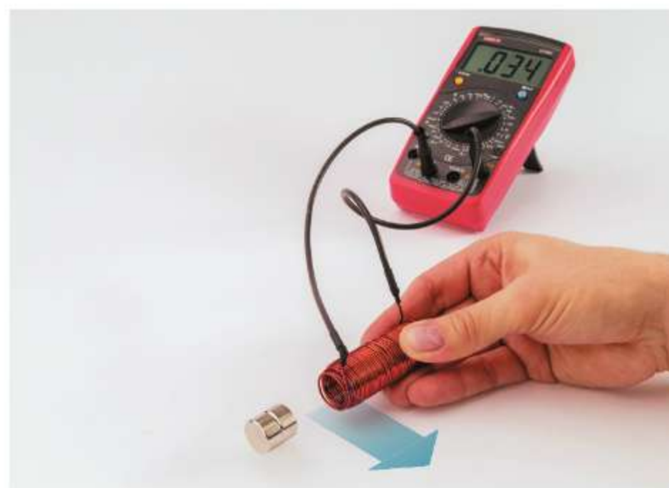
Ryc. 19.3. Zwojnica porusza się w kierunku prostopadłym do osi magnesu
