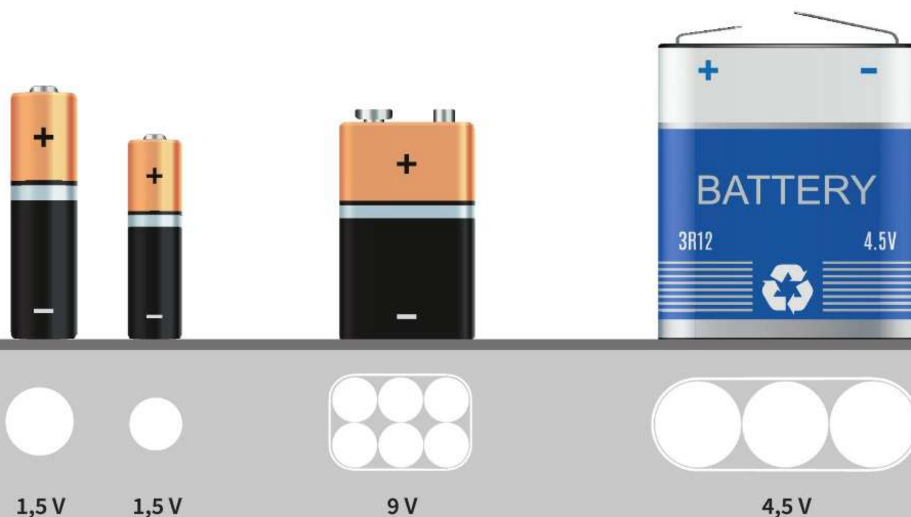
Ryc. 9.7. Baterie mogą składać się z wielu ogniw
