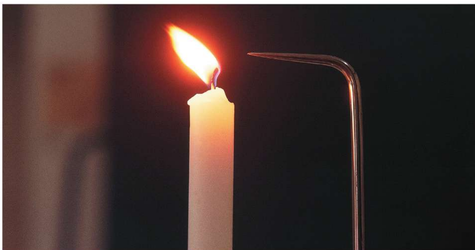
Ryc. 6.5. Płomień świecy odchyła się w pobliżu silnie naelektryzowanego ostrza
