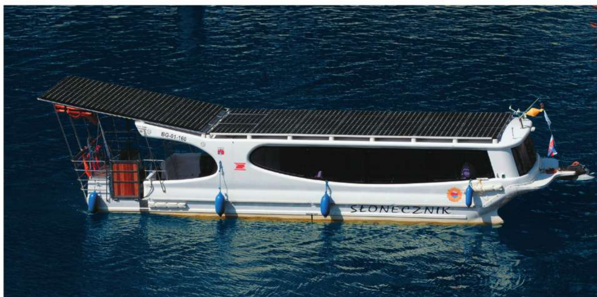
Ryc. 31.5. Tramwaj wodny w Bydgoszczy, zasilany przez ogniwa fotoelektryczne
