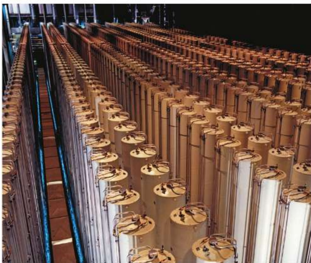
Ryc. 40.1. Hala fabryki wzbogacania uranu. Aby otrzymać odpowiednie stężenie uranu ^{235}\text{U} , proces wirowania należy powtarzać wiele razy
