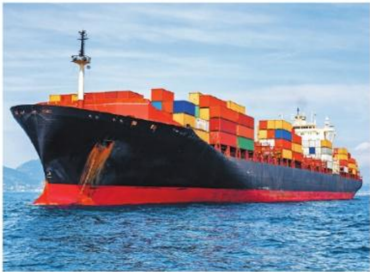
4.18 Ciężar statku wraz z ładunkiem jest zrównoważony siłą wyporu równą ciężarowi wody o objętości zanurzonej części
