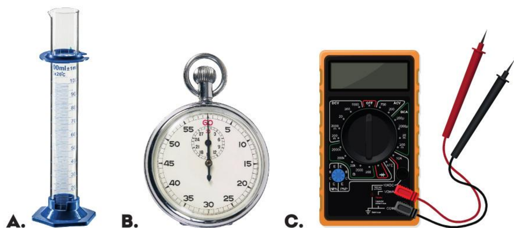
1.8 Przyrządy pomiarowe: A. cylinder miarowy, B. stoper, C. miernik
