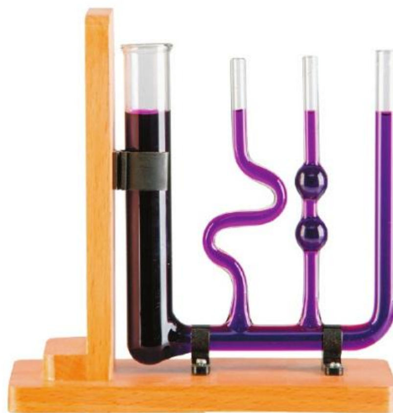
4.7 A. Naczynia połączone, B. System naczyń połączonych wykorzystywany w konstrukcji wieży ciśnień oraz domowej instalacji wodociągowej
