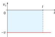
Rys. 4.10 Wykres v_x(t) w ruchu jednostajnym prostoliniowym, w którym zwrot prędkości jest przeciwny do zwrotu osi x
