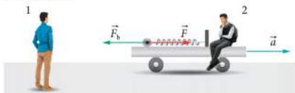
Rys. 15.6 Obserwator 2: Siłę \vec{F} równoważy siła bezwładności
