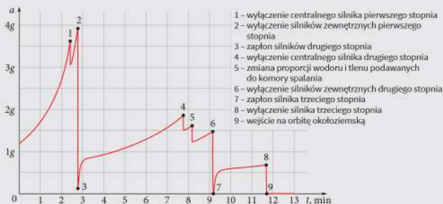
Wykres 2. Zależność od czasu tzw. przyspieszenia wzdłużnego (czyli przyspieszenia, które uzyskalaby rakieta, gdyby działała na nią tylko siła ciągu silników), wyrażonego wzorem \vec{a} = -\frac{\Delta m}{\Delta t} \cdot \frac{\vec{v}_{wzgl}}{M}
