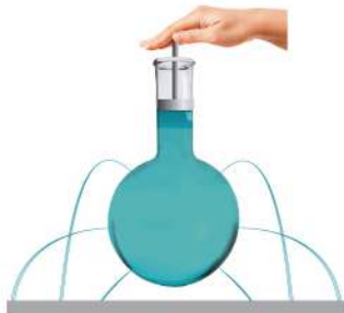
Rys. 22.1 Obserwacja słuszności prawa Pascala
