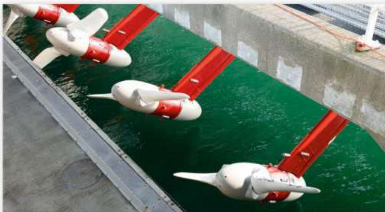
Ryc. V.6.2. Elektrownie pływowe do wytwarzania energii wykorzystują regularne zmiany poziomu wody związane z pływami. Woda przepływa przez turbiny, wytwarzając prąd. Elektrownie te nie mogą wytwarzać energii elektrycznej w sposób ciągły, ponieważ w momencie wyrównywania się poziomów wody w morzu i zbiorniku spadek wody jest tak mały, że uniemożliwia pracę turbin. Hydroelektryczna stacja pływowa z turbinami pływowymi w Oosterschelde (Holandia).
