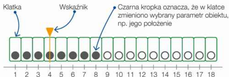
Rys. 19.3. Schemat osi czasu w programie do tworzenia animacji komputerowych
