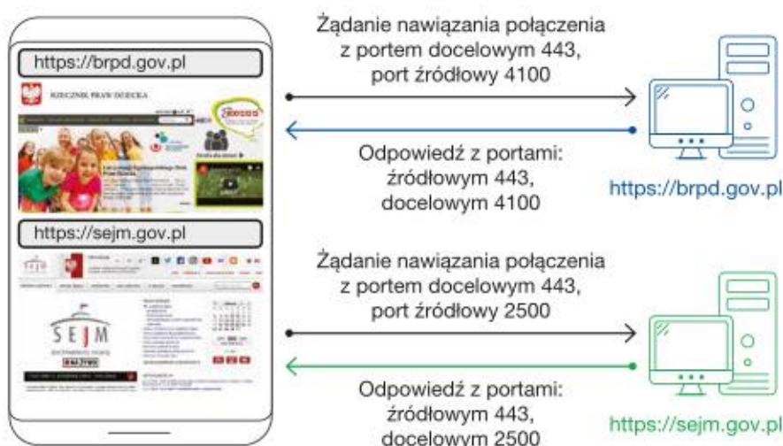
Rys. 4.14. Mechanizm działania portów
