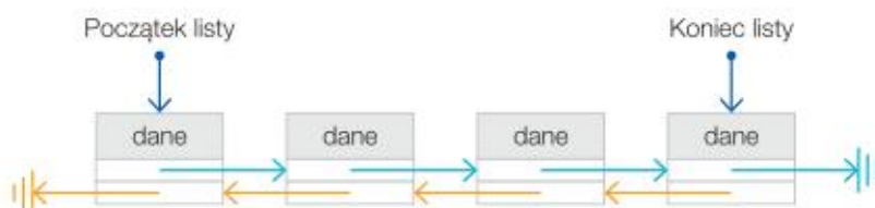
Rys. 3.3. Przykład listy dwukierunkowej złożonej z czterech elementów
