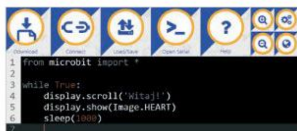
Rys. 19.8. Programowanie płytki micro:bit w języku MicroPython
