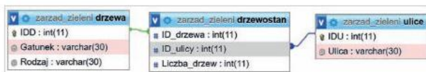
Rys. 16.14. Związki między tabelami widoczne w zakładce Widok projektu narzędzia phpMyAdmin
