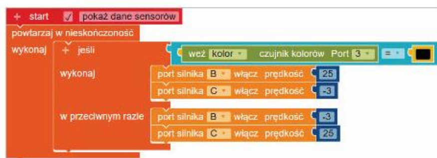
Rys. 19.16. Kod źródłowy programu Jazda po ścieżce
