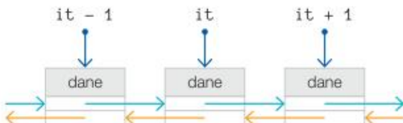
Rys. 3.8. Fragment listy z wartościami iteratorów it , it - 1 oraz it + 1
