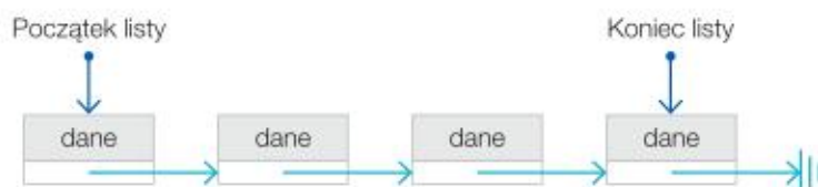
Rys. 3.1. Przykład listy jednokierunkowej złożonej z czterech elementów
