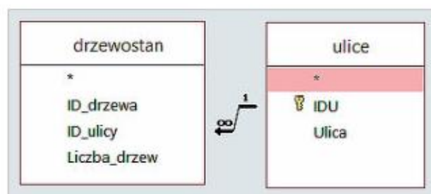
Rys. 17.11. Relacja ze sprzężeniem odpowiadającym klauzuli LEFT JOIN
