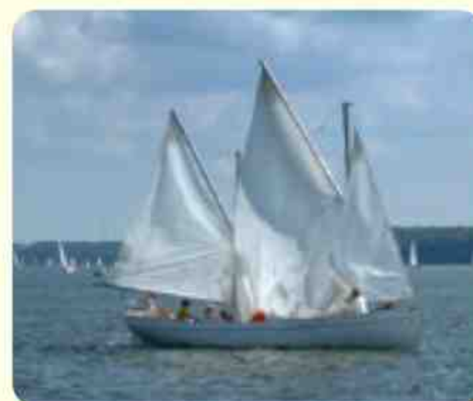
DZ (Dezeta) załoga: do 12 osób dł. 8,50 m, szer. 2,15 m masa: 1120 kg ożaglowanie: grot 15,70 \text{ m}^2 , fok 3,90 \text{ m}^2 , bezan 9,50 \text{ m}^2
