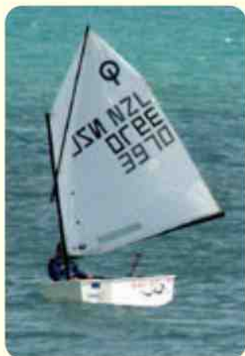
Optymist załoga: 1 osoba dł. 2,32 m, szer. 1,13 m masa: 35 kg ożaglowanie: grot 3,5 \text{ m}^2
