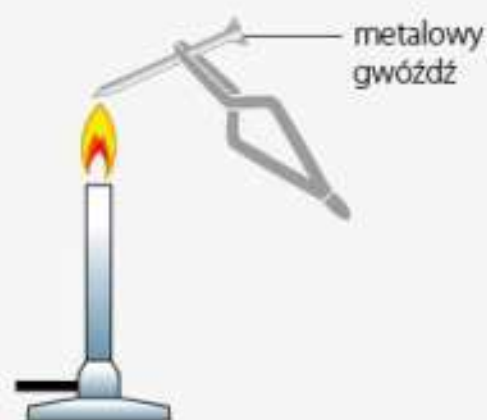
Rys. 7.2. Ogrzewanie przedmiotu wykonanego z metalu w płomieniu palnika.
