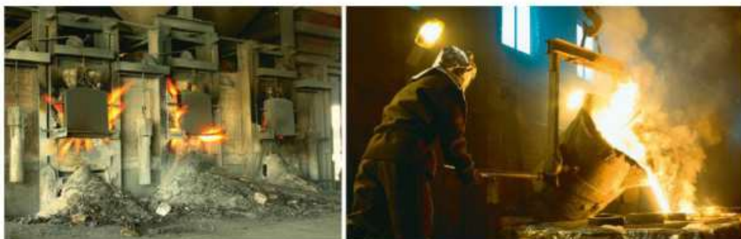
Rys. 8.2. Stal otrzymuje się przez przeróbkę surówki w hutach, m.in. w piecach martenowskich (a), a żeliwo – w piecach nazywanych żeliwiakami (b).
