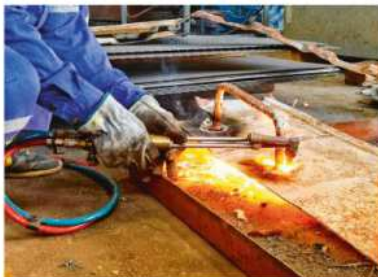
Rys. 6.5. Tlen używa się palnikami acetylenowo-tlenowymi służącymi do spawania i cięcia materiałów wykonanych z metali i ich stopów.
