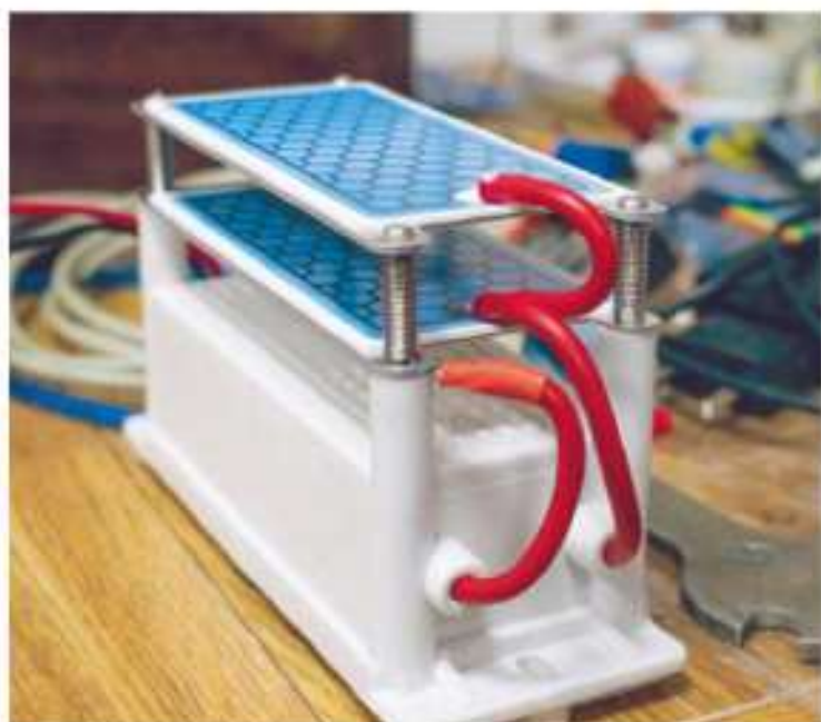
Rys. 6.3. Do celów dezynfekcyjnych otrzymuje się ozon z powietrza w wyniku wyładowań elektrycznych w urządzeniach nazywanych ozonatorami.
