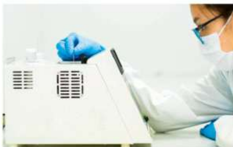
Rys. 4.1. Temperatury topnienia można wyznaczyć za pomocą termometru umieszczonego wewnątrz przyrządu do oznaczania temperatury topnienia ciał stałych.
