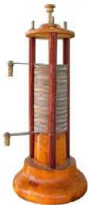
Rys. 10.2. Jedna z wersji ogniw skonstruowanego przez Voltę, nazwana stołem Volty, została zbudowana z na przemian ułożonych krążków miedzianych
