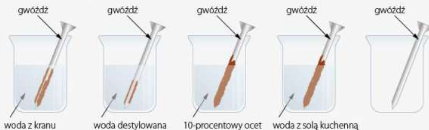
Rys. 12.6. Korozja stalowego gwoźdźcia pod wpływem różnych substancji.
