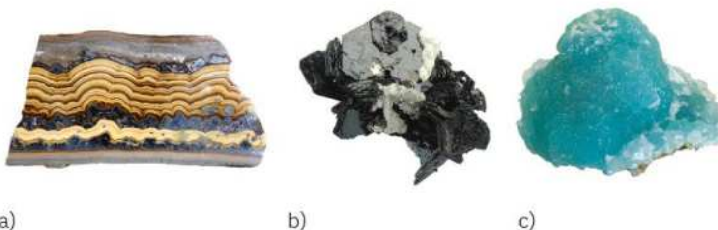
Rys. 7.9. Do celów przemysłowych cynk jest pozyskiwana z blendy cynkowej (a), wurcytu (b) oraz smitsonitu (c).
