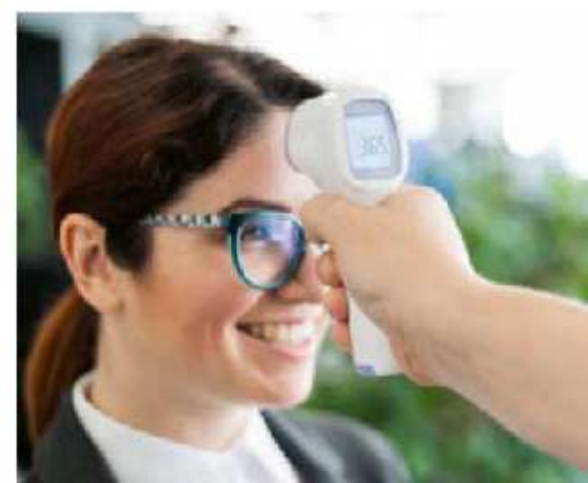
Rys. 19.35. Pomiar długości fali dominującej w promieniowaniu termicznym skóry człowieka pozwala zmierzyć temperaturę szybko i bez kontaktu
