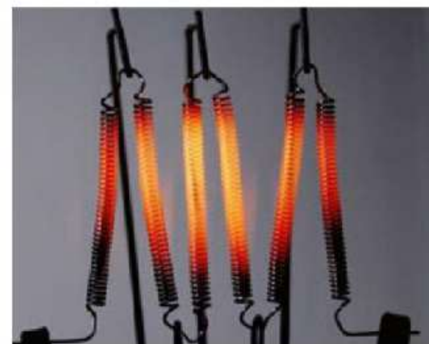
Rys. 19.36. Gołym okiem widzimy, które części spirali są najbardziej rozgrzane
