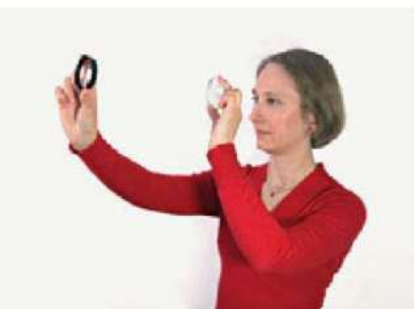
Rys. 18.29. Najprostszy działający model lunety astronomicznej
