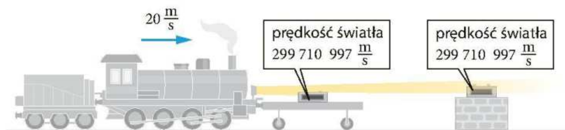
Rys. 21.3. Dwa mierniki prędkości światła, jeden na wagonie pchanym przez lokomotywę, a drugi na ziemi, wskazują dokładnie tę samą wartość, mimo że są względem siebie w ruchu
