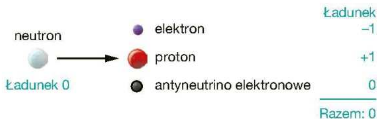
Rys. 20.13. Zachowanie ładunku w rozpadzie beta minus
