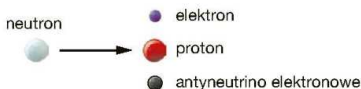
Rys. 20.9. Schemat rozpadu beta minus pojedynczego neutronu
