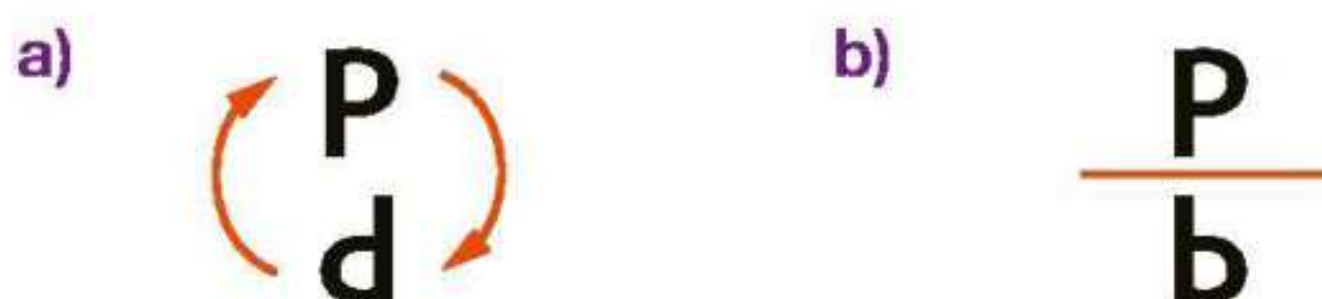
Rys. 18.13. Obraz tworzony przez soczewkę jest odwrócony (a), a nie odbity (b)
