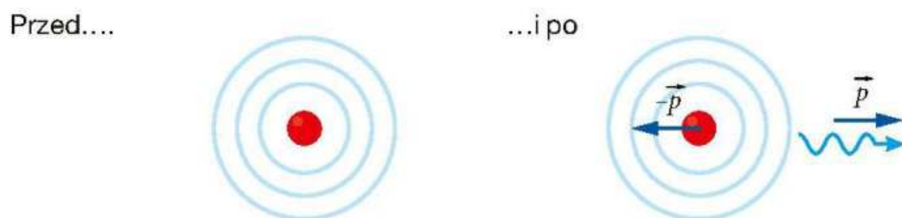
Rys. 19.24. Zmiana pędu atomu przy emisji fotonu
