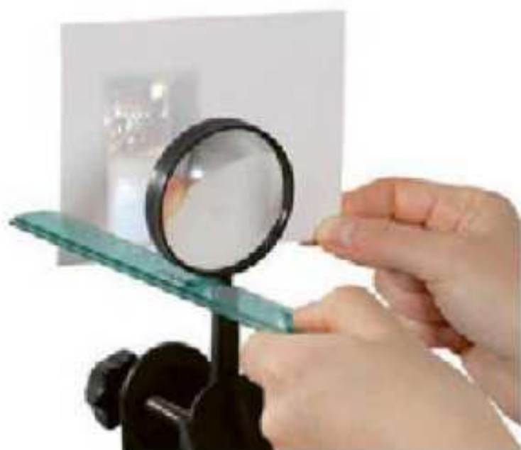
Rys. 18.20. Pomiar ogniskowej soczewki skupiającej
