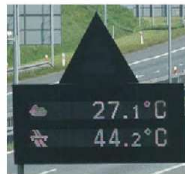
Rys. 19.30. Asfalt pochłania promieniowanie słoneczne (zarówno światło widzialne, jak i podczerwień), więc mocno rozgrzewa się w słoneczny dzień
