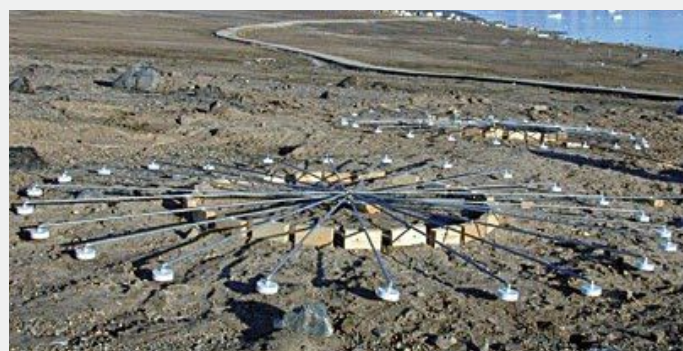
Stacja IMS do odbioru infradźwięków
