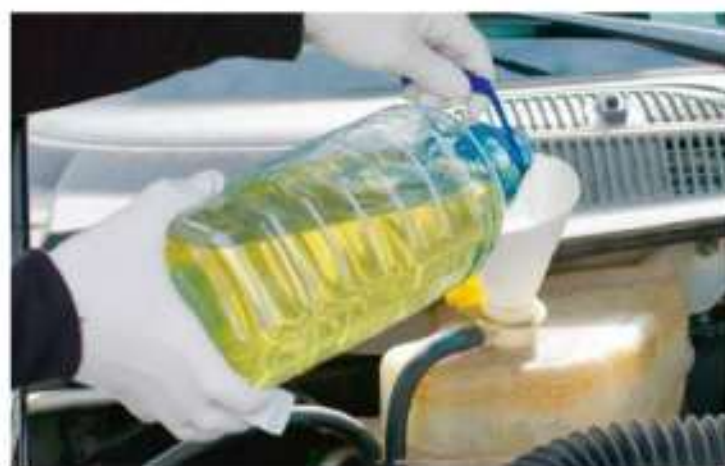
Rys. 1.3. Glikol etylenowy (alkohol glikolowy) jest stosowany jako składnik płynów chłodzących w samochodach.
