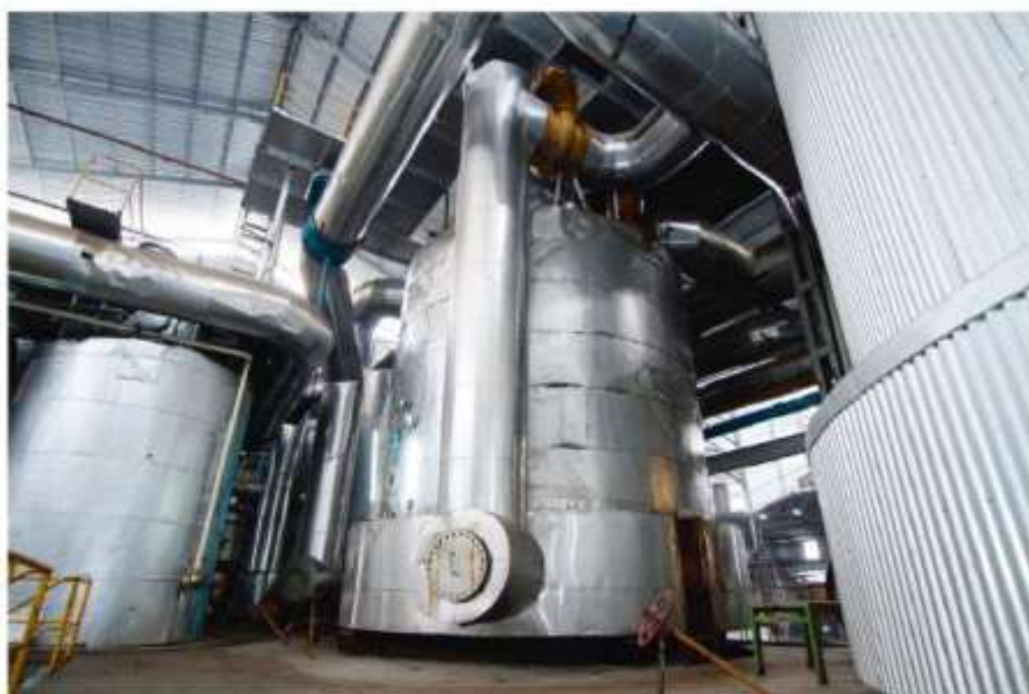
Rys. 7.5. Fragment linii produkcyjnej w cukrowni służący do prowadzenia krystalizacji.
