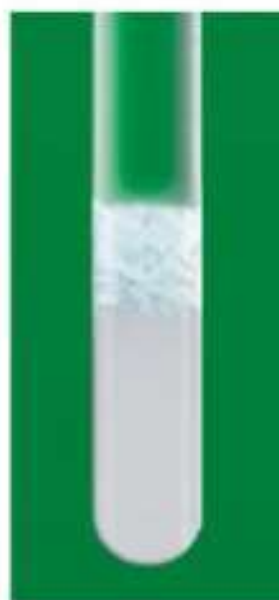
B osad otrzymanego produktu (górną warstwę) odbarwienie wody bromowej (dolną warstwę)
