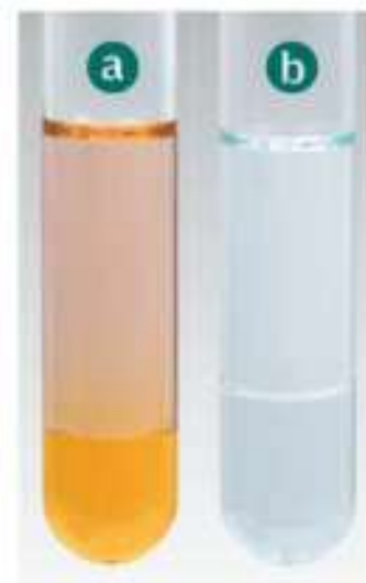
Rys. 13.2. a) Toluen po dodaniu mieszaniny nitrującej, b) heksan po dodaniu mieszaniny nitrującej.
