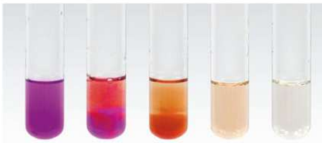
Rys. 2.1. Kiedy do zakwaszonego roztworu manganianu(VII) potasu dodajemy etanol, następuje stopniowe odbarwienie roztworu.
