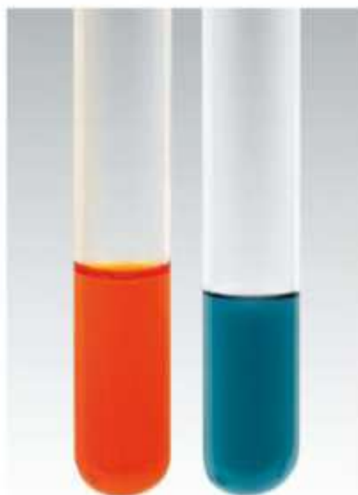
Rys. 5.1. Produktem reakcji propan-2-olu z dichromianem(VI) potasu jest propanon i sól chromu(III).
