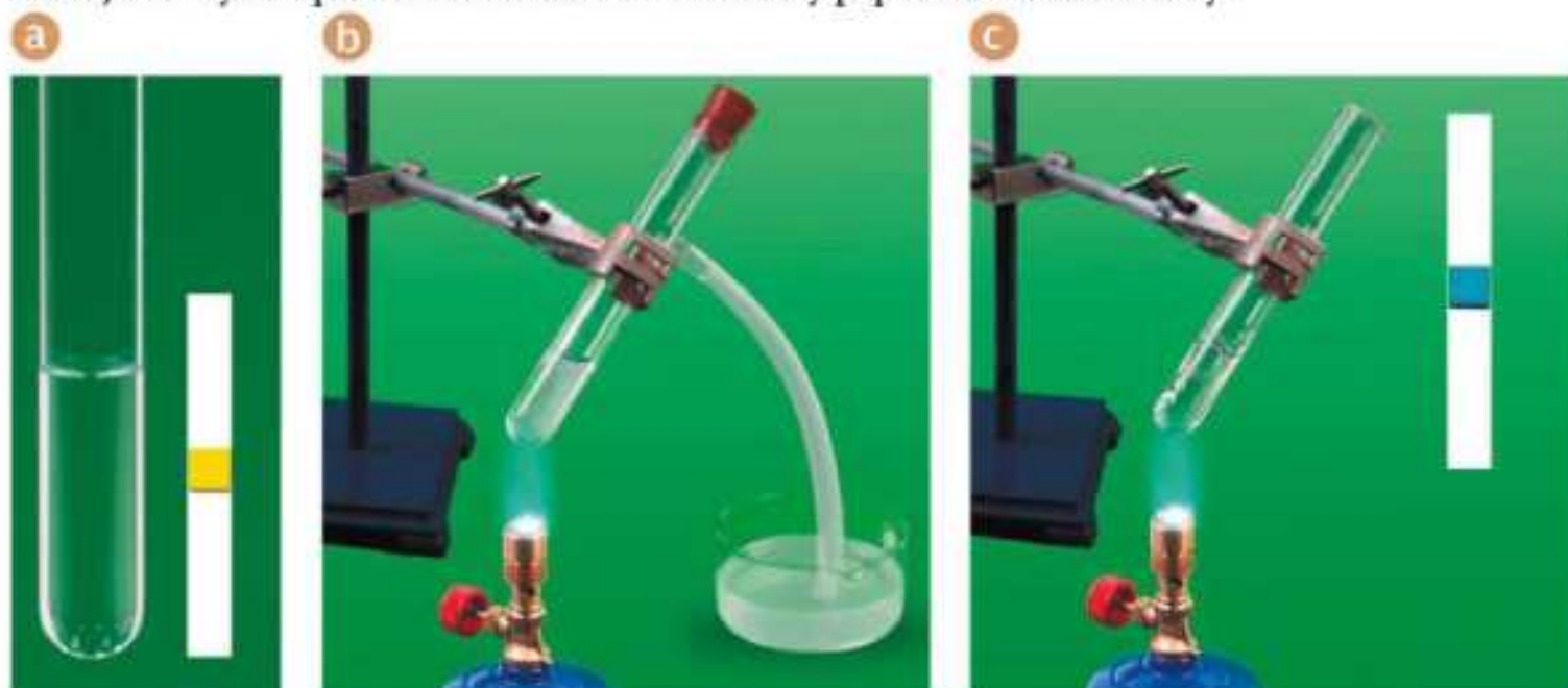
Rys. 3.1. Badanie właściwości mocznika. a) Uniwersalny papierek wskaźnikowy nie zmienia zabarwienia w roztworze mocznika. b) Ogrzewanie roztworu mocznika z dodatkiem kwasu solnego prowadzi do wydzielenia gazu, który powoduje mętnienie wody wapiennej. c) Ogrzewanie roztworu mocznika z dodatkiem wodorotlenku sodu prowadzi do wydzielenia gazu o charakterystycznym zapachu, który zmienia barwę uniwersalnego papierka wskaźnikowego na niebieską.
