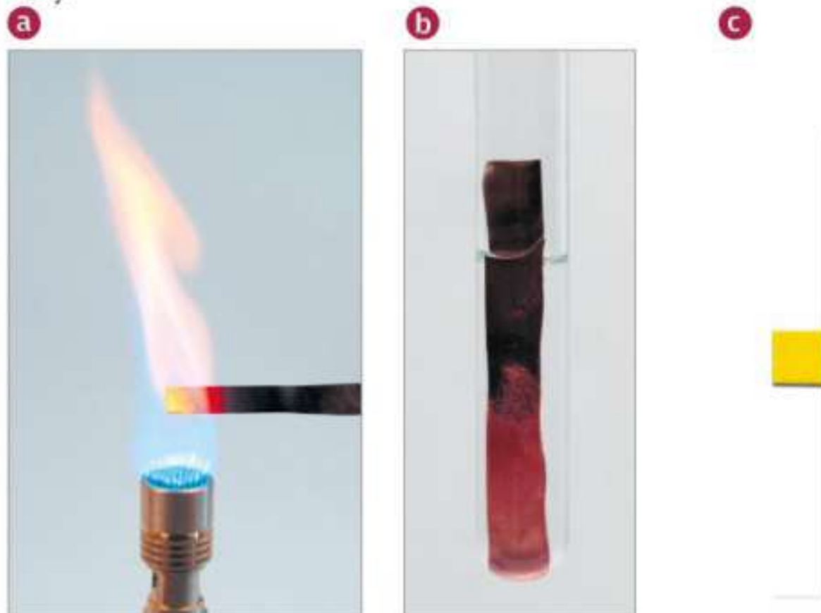
a) Ogrzewanie miedzi w płomieniu palnika, b) gorący drut miedziany tuż po wprowadzeniu do etanolu, c) barwa uniwersalnego papierka wskaźnikowego po zanurzeniu w roztworze etanolu.
