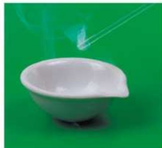
Rys. 2.3. Wokół zwilżonego w trietyloaminie końca bagietki powstają białe dymy.
