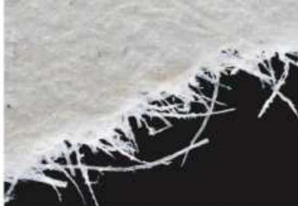
Rys. 1.6. Mikrofotografia krawędzi kartki papieru uzyskana za pomocą mikroskopu elektronowego.
