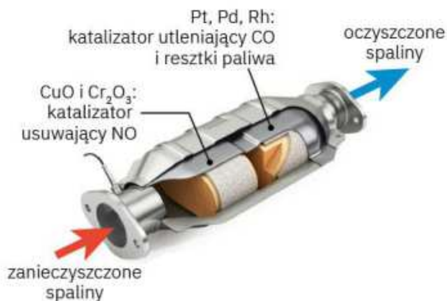
Rys. 1.7. Schemat działania katalizatora samochodowego. Katalizator składa się z dwóch części roboczych, zbudowanych z porowatego materiału ceramicznego, na którym są osadzone aktywne składniki katalizatora. W pierwszej części, zawierającej tlenek miedzi(II) i tlenek chromu(III), następuje rozkład tlenku azotu(II) na pierwiastki: 2\text{NO}_{(g)} \rightarrow \text{N}_{2(g)} + \text{O}_{2(g)} . W drugiej części zachodzi utlenienie toksycznego tlenku węgla(II) i resztek paliwa, katalizowane metalami: platyną Pt, palladem Pd i rodem Rh: 2\text{CO}_{(g)} + \text{O}_{2(g)} \rightarrow 2\text{CO}_{2(g)} , 2\text{C}_8\text{H}_{18(g)} + 25\text{O}_{2(g)} \rightarrow 16\text{CO}_{2(g)} + 18\text{H}_2\text{O}_{(g)} .
