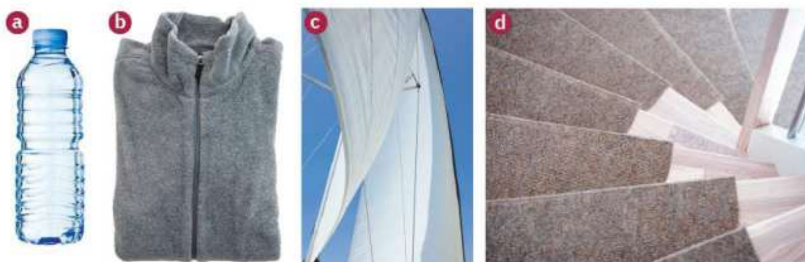
Rys. 2.8. Wyroby z PET: a) butelka na napoje, b) ciepła bluza z polaru, c) żagle z dakronu, d) wykładzina dywa- nowa.
