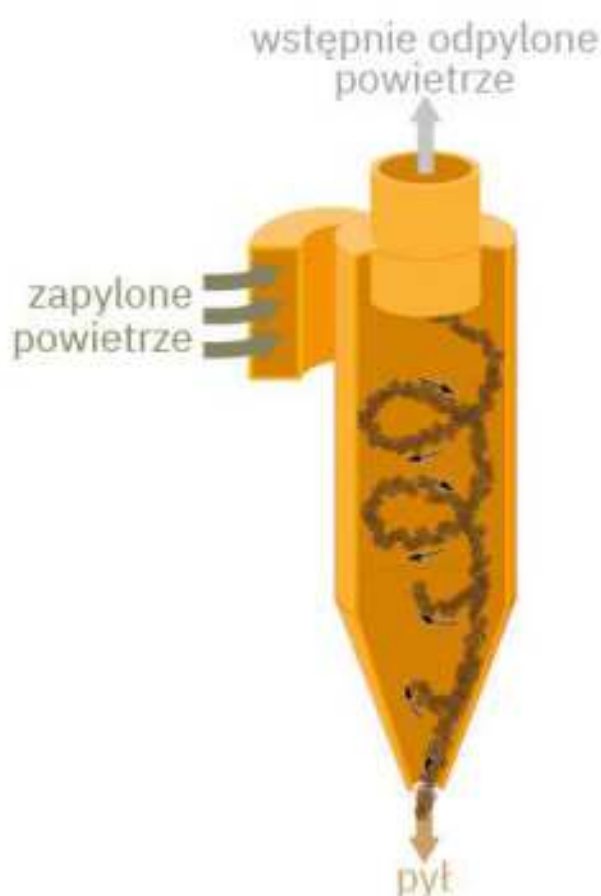
Rys. 1.3. Schemat odpylania odlotowych gazów przemysłowych za pomocą cyklonu. Zapyłony gaz zostaje wprowadzony w ruch wirowy wewnątrz cyklonu. Dzięki sile odśrodkowej pył osadza się na ścianach i zsuwa się w dół, gdzie jest odbierany.
