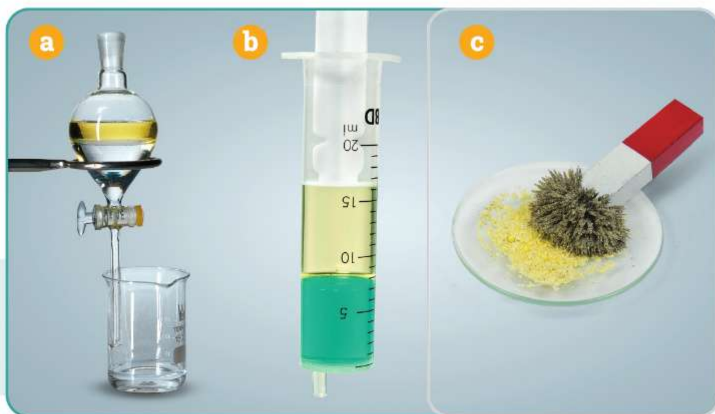
Rozdzielanie rozdzielaczem (a), strzykawką (b) i magnesem (c)
