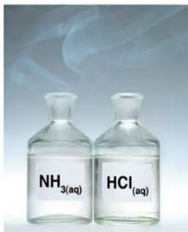
▲ Amoniak reaguje z chlorowodorem i tworzy drobne, rozproszone w powietrzu kryształki \text{NH}_4\text{Cl}
