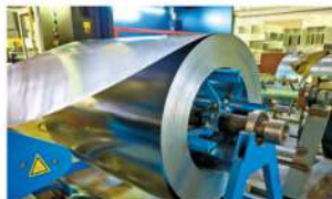
▲ Rolka z ocynkowanej blachy stalowej do produkcji metalowych rur
