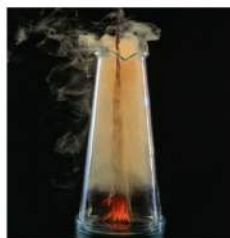
▲ Brunatny dym to rozproszone w kolbie kryształki tworzącego się produktu reakcji miedzi z chlorem – \text{CuCl}_2
