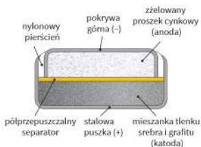
▲ Budowa ogniwa srebrowo-cynkowego
