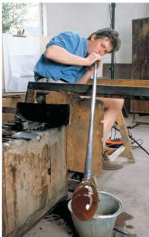
▲ Gorąca masa szklana jest plastyczna i dzięki temu można ją dowolnie formować
