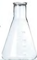
Kolba stożkowa do przechowywania lub ogrzewania substancji i mieszanin
