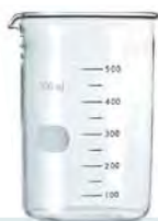
Zlewka do przygotowywania i ogrzewania cieczy
