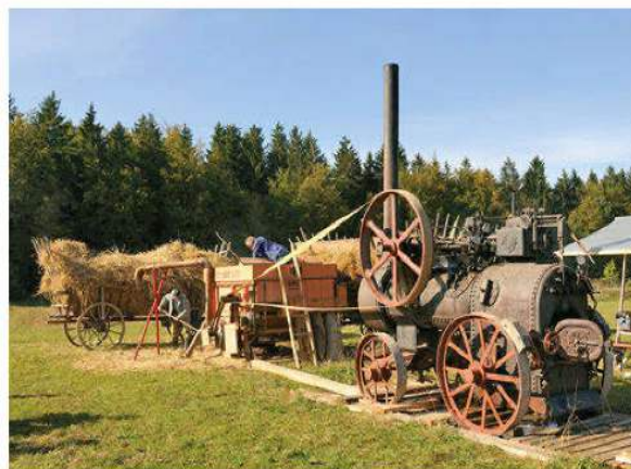
Lokomobila podczas prac polowych mogła napędzać młockarnię, czyli maszynę oddzielającą ziarna od kłosów.
