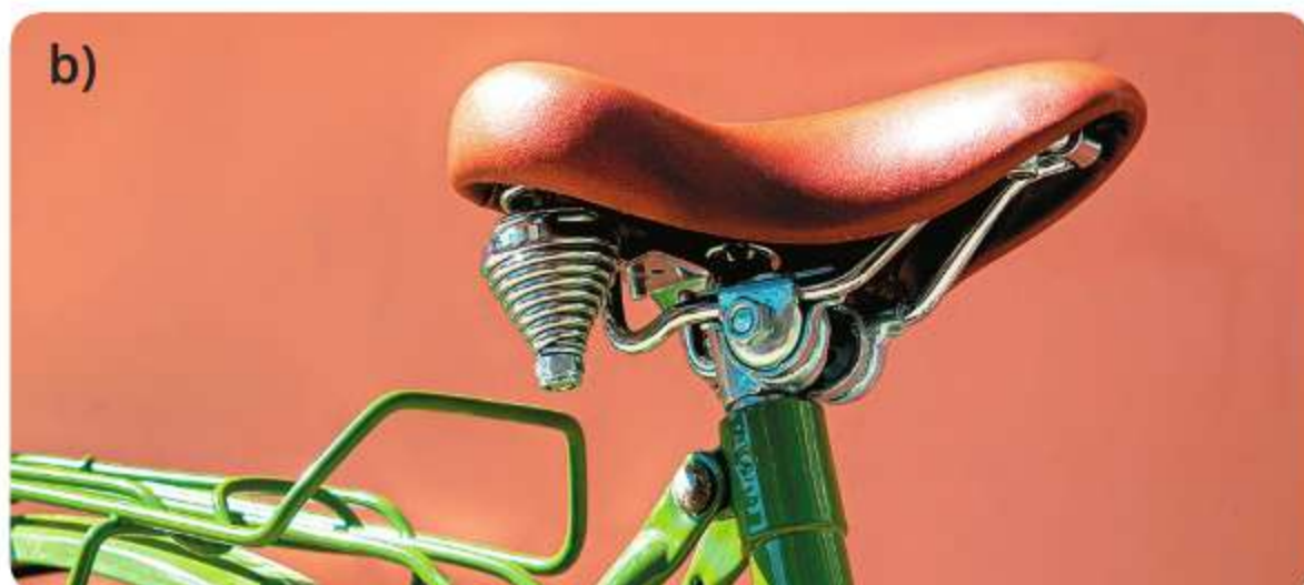
Ryc. 3.1. Przykłady drgań, z którymi są związane przemiany energii: kula wyburzeniowa (a), sprężyna pod siodełkiem (b).
