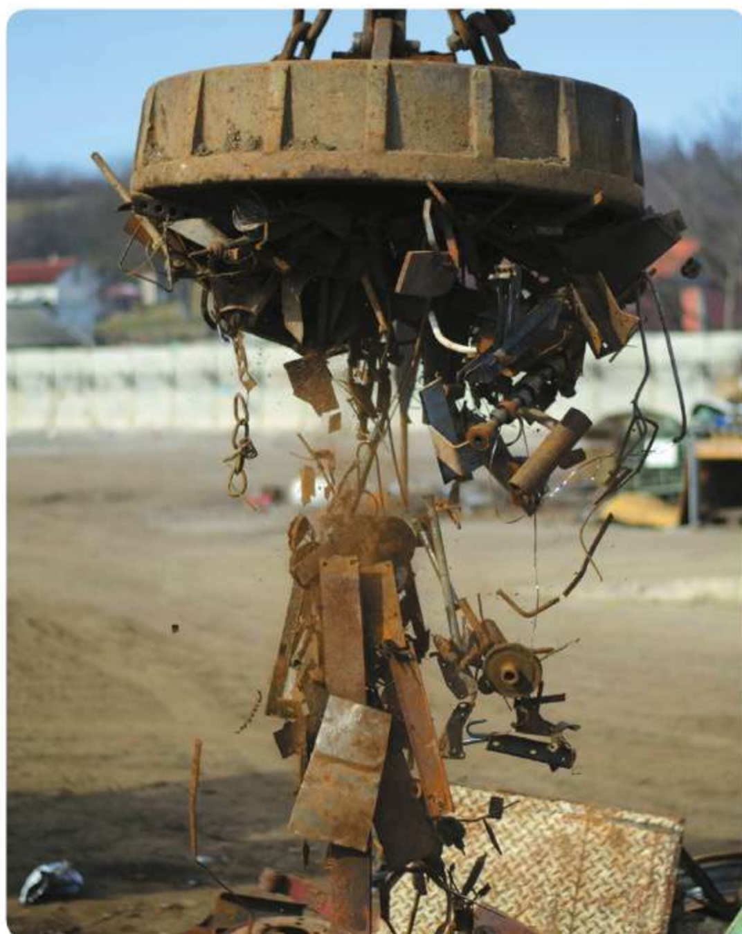
Ryc. 22.1. Elektromagnes przenoszący złom na złomowisku
