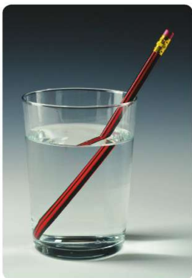
Ryc. 29.2. Odbicie i załamanie światła na granicy ośrodków
