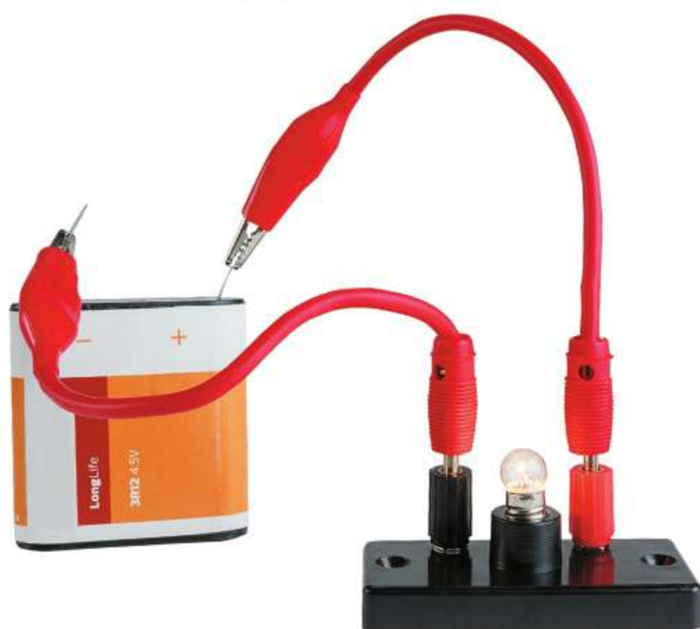
Ryc. 14.4. Obwód elektryczny składający się z żarówki w podstawce zakończonej dwoma wyprowadzeniami (połączonymi z żarówką), baterii (źródła napięcia) oraz przewodów
