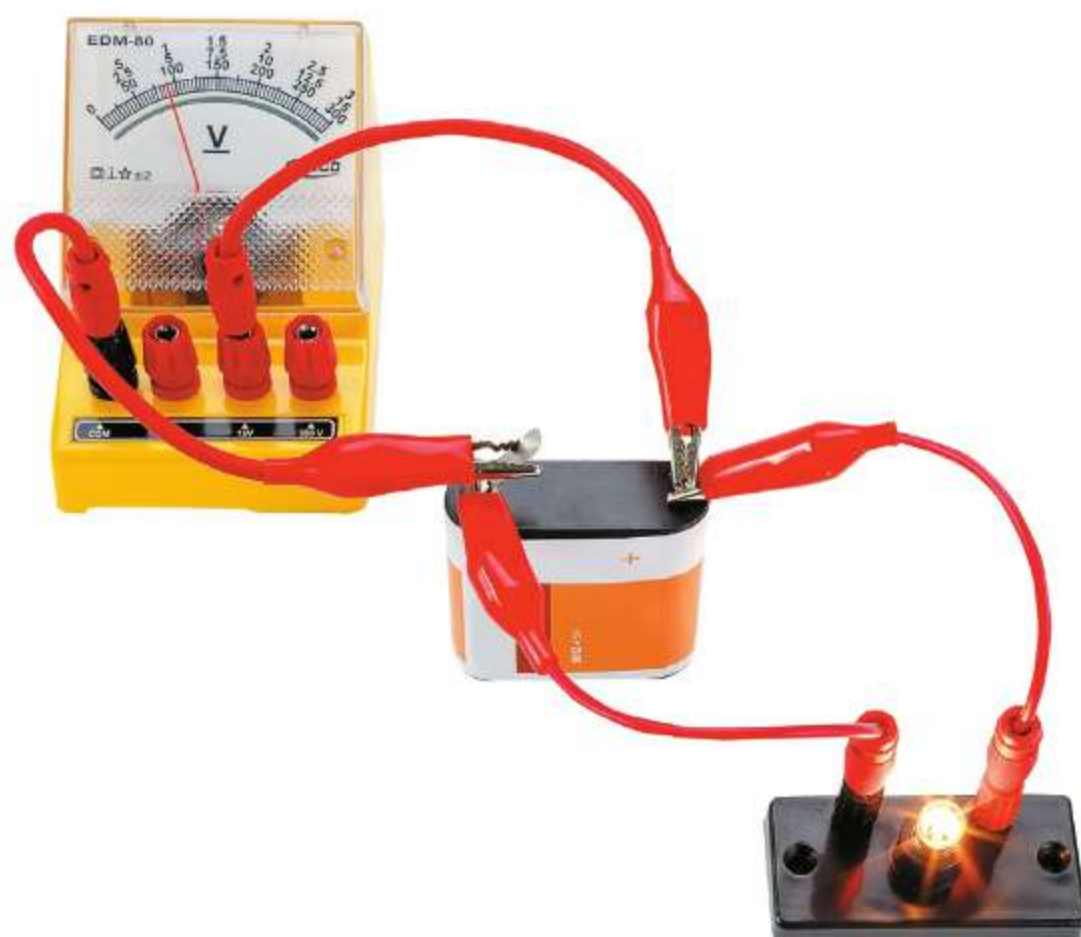
Ryc. 14.6. Woltomierz podłączony do źródła napięcia (a) i woltomierz podłączony do odbiornika energii elektrycznej (b)
