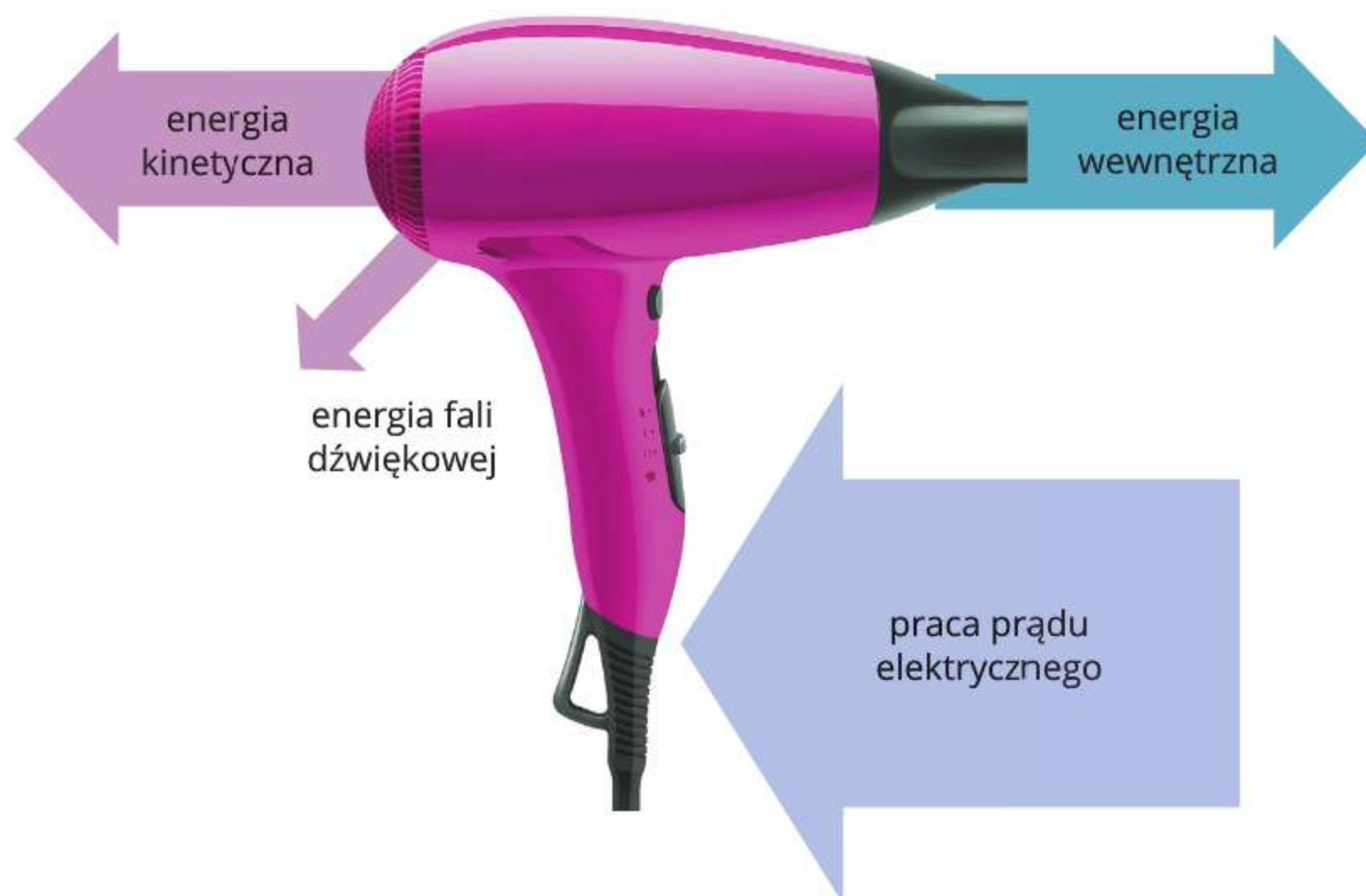
Ryc. 19.2. Schemat przemian energii zachodzących w suszarce
